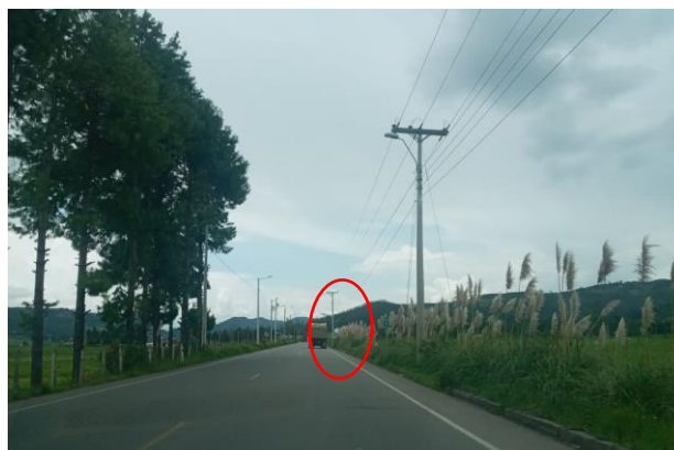
Ilustración 5 Señalización de intersecciones tapadas por vegetación. Fuente: Propia
