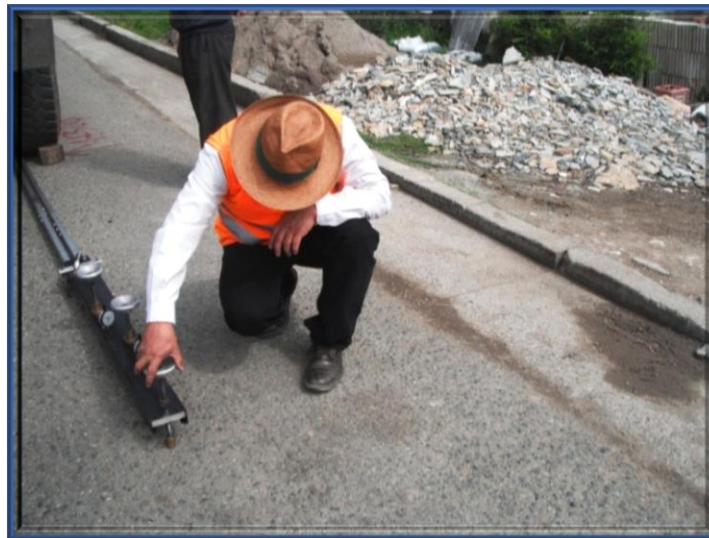
Fotografía 22. Colocación típica de la Viga de Benkelman en coordinación con el laboratorista del GAD MUNICIPAL DEL CANTON CUENCA Sr. William Lituma
