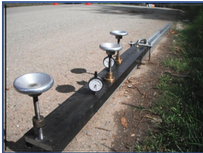
Fotografía 23. Viga de Benkelman
