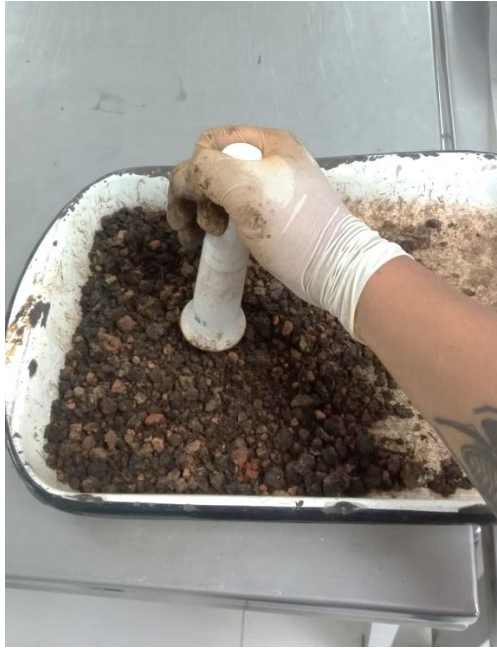
Figura 42: Trituración de suelo para análisis.
