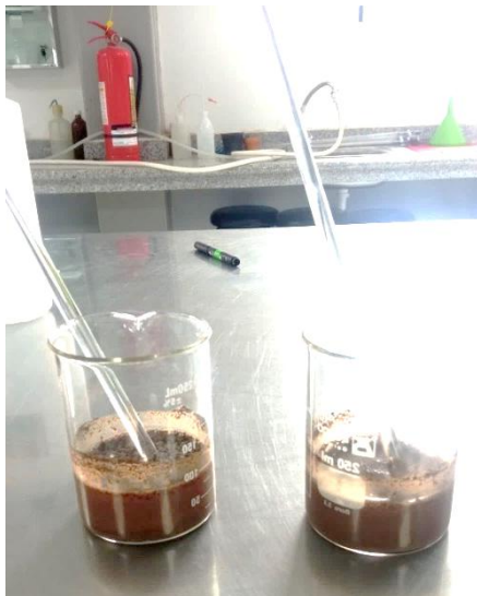
Figura 10: Mezcla del agua destilada con el suelo.
