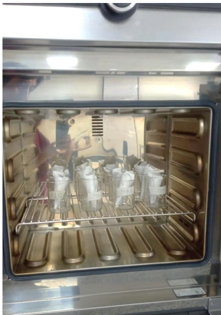
Figura 26: Procesos de desecado de las muestras en la estufa por 24h a 110 C°.
