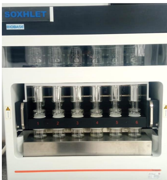
Figura 31: Proceso de extracción de HTPs en el solvente alcohol metílico, de las muestras contaminadas, por medio del Soxhlet.
