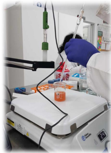
c) Colocación del reactivo NaOH
