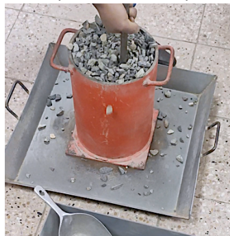
Compactación 3 ra capa
