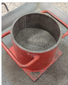
Compactación 2 da capa
