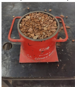
Compactación 3 ra capa
