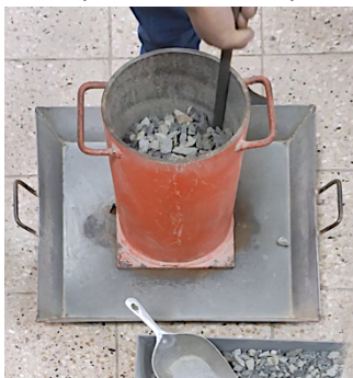
Compactación 2 da capa
