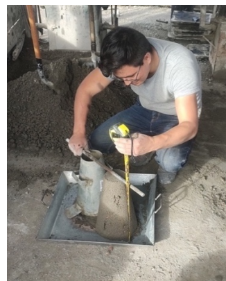
Ensayo de asentamiento
