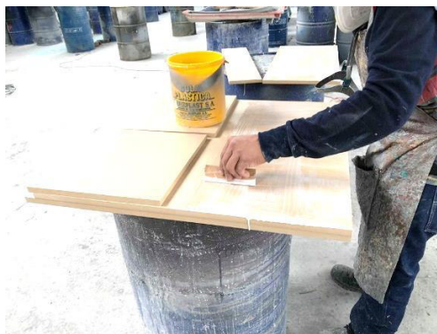
Fotografía 4. Unión de placas de MDF mediante pegamento y Clavos
