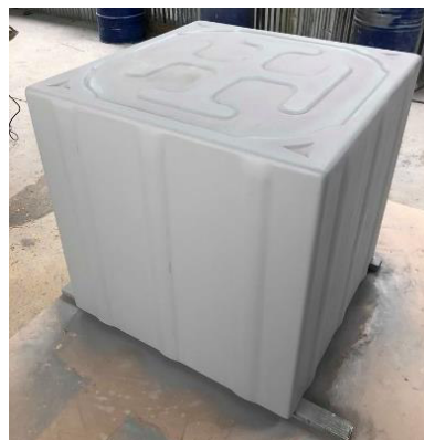
Fotografía 10. Fondo terminado sobre el pre-molde
