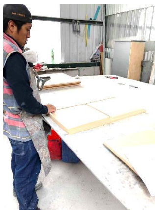
Fotografía 2. Utilización de MDF en varias capas para modelar elementos Elaborado Por: Álvaro Ávila
