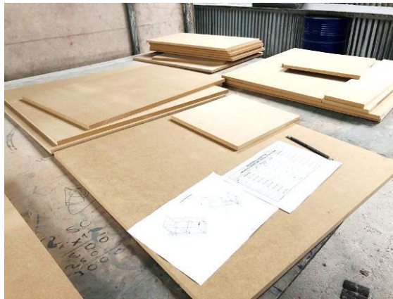
Fotografía 1. Proceso de construcción del pre-molde con Madera MDF Elaborado Por: Álvaro Ávila
