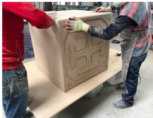
Fotografía 8. Montaje de Rigidizadores en Pre-molde de MDF
