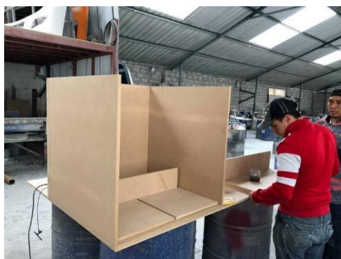
Fotografía 5. Creación del pre-molde en MDF, elementos horizontales, verticales y otros.
