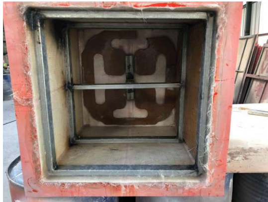
Fotografía 12. Estructura de metal para evitar deformaciones sobre el MDF Elaborado Por: Álvaro Ávila
