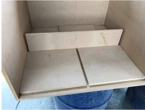
Fotografía 6. Vista interior del pre-molde de MDF
