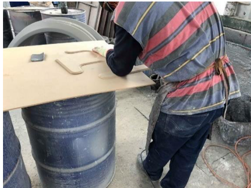
Fotografía 7. Elaboración de Rigidizador de MDF para Pre-molde
