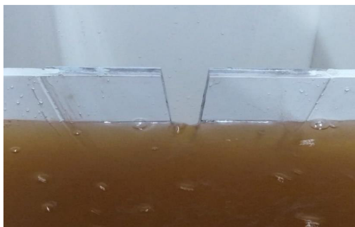
Fotografía 16. Paso de agua y determinación de niveles en el vertedero triangular. Elaborado Por: Álvaro Ávila
