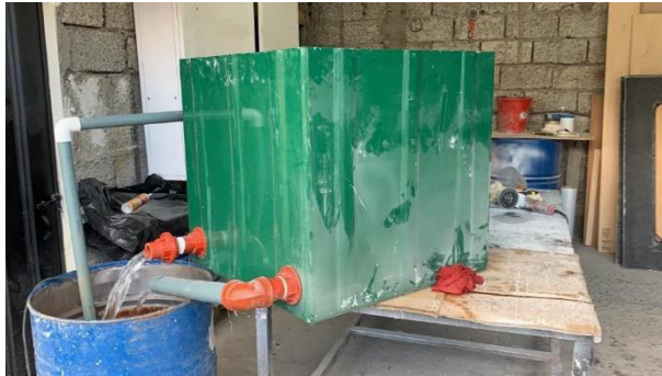
Fotografía 14. Abastecimiento y recirculación de agua sobre el prototipo Elaborado Por: Álvaro Ávila
