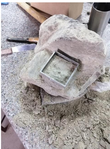
Figura 41. Labrado de probeta ensayo corte directo
