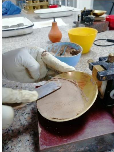
Figura 34. Colocación del material para realizar ensayo de la cuchara de Casagrande
