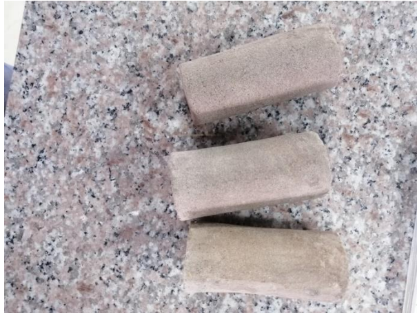
Figura 45. Muestras labradas de material inalterado para ensayo triaxial
