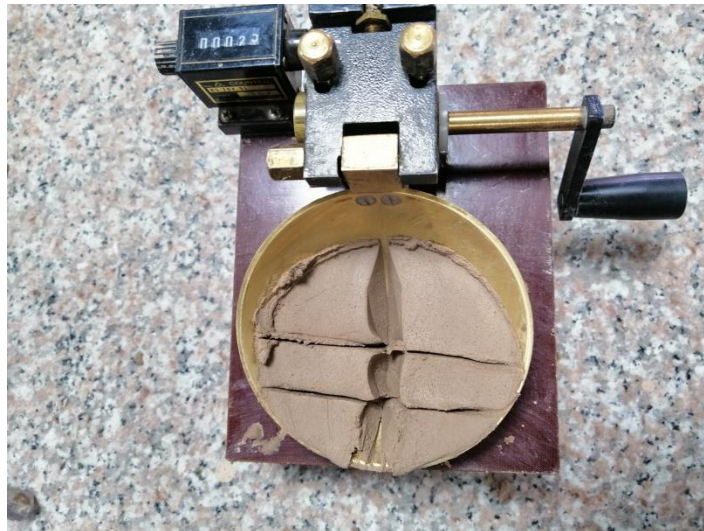
Figura 35. Porción de material que entró en contacto al realizar el ensayo de la cuchara de Casa grande luego de 25 golpes
