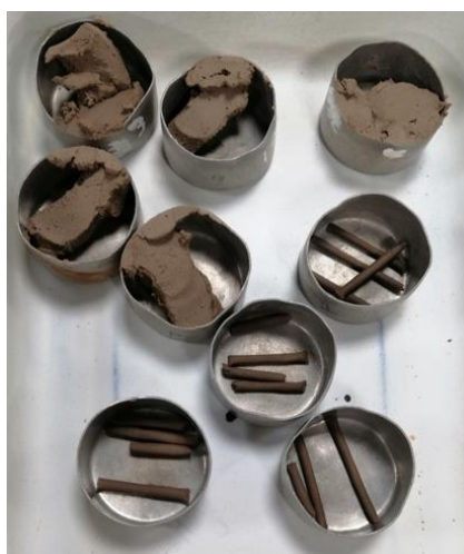
Figura 40. Material utilizado para la determinación de L.L. y L.P. antes del secado
