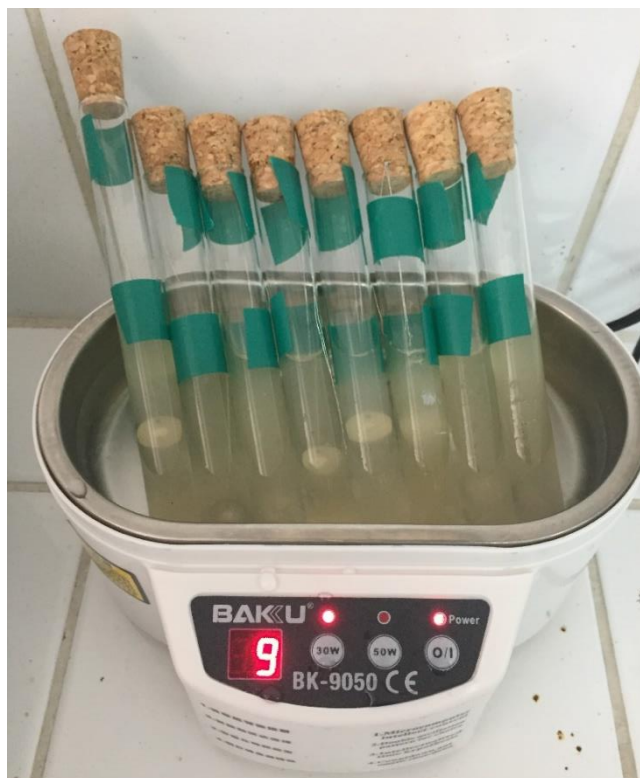
Fig. 6: Muestras de cemento sumergidas en aceite de eucalipto en un ambiente ultrasónico.
