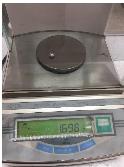
Fig. 4: Balanza digital utilizada durante el pesaje inicial y final de las muestras de cemento sellador.
