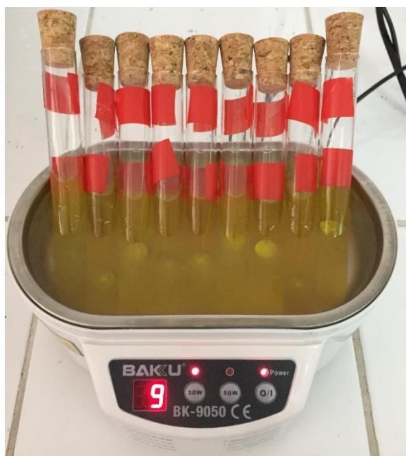
Fig. 6: Muestras de cemento sumergidas en aceite de naranja en un ambiente ultrasónico.
