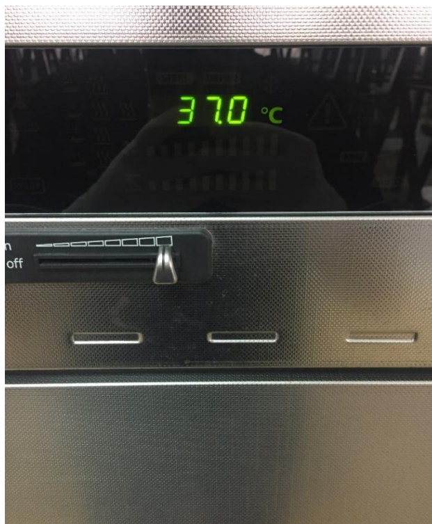
Fig. 3: Temperatura requerida para la incubadora durante el fraguado de las muestras de cemento, simulando la temperatura corporal normal.
