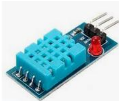
Figura 2. Sensor de temperatura y humedad DHT11 Fuente. (Access & Shield, 2012)
