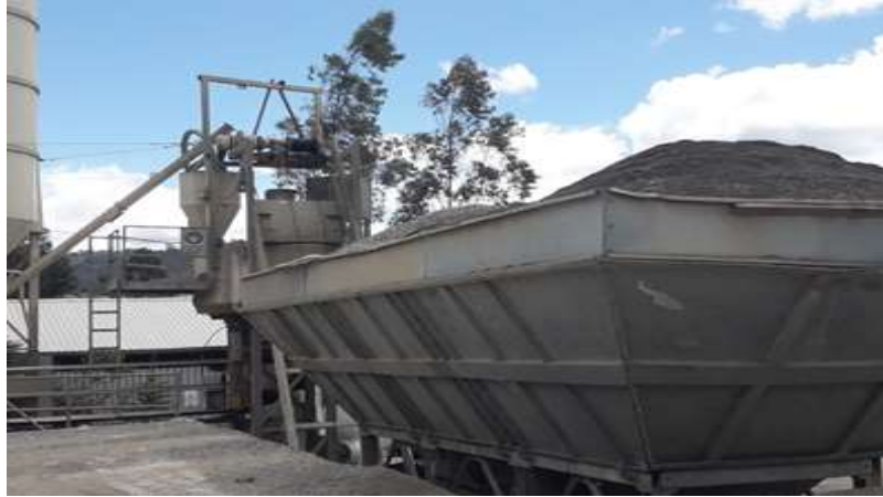
Figura 5: Carga de los áridos a las tolvas Fuente: Planta Hormi – Center Elaborado por: Autora
