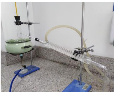
Anexo 15. Equipos de Destilación
