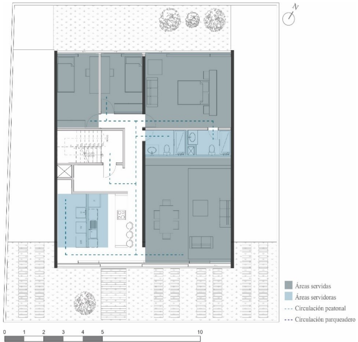
Figura 60: Áreas Servidas planta tipo Edificio Jacobo
