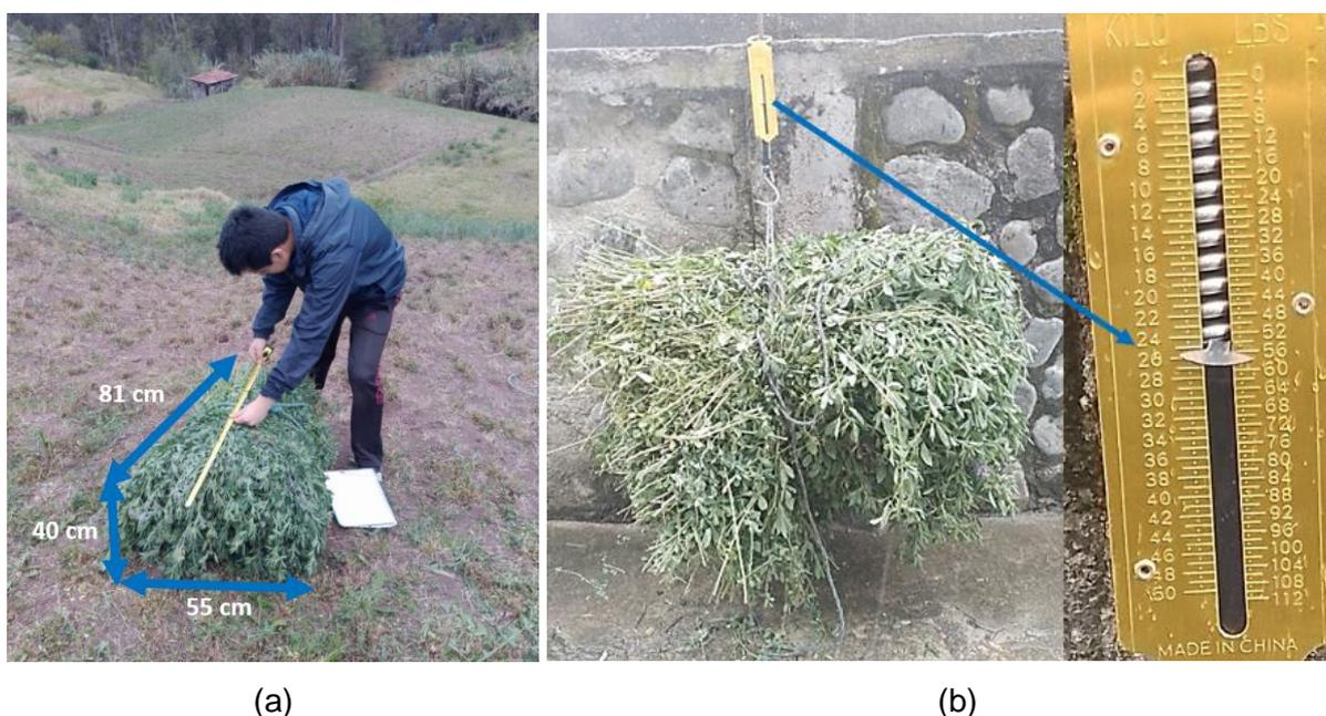
Figura 61. Mediciones de la carga. (a) Mediadadas del tamaño de la carga. (b) Masa de la carga.
