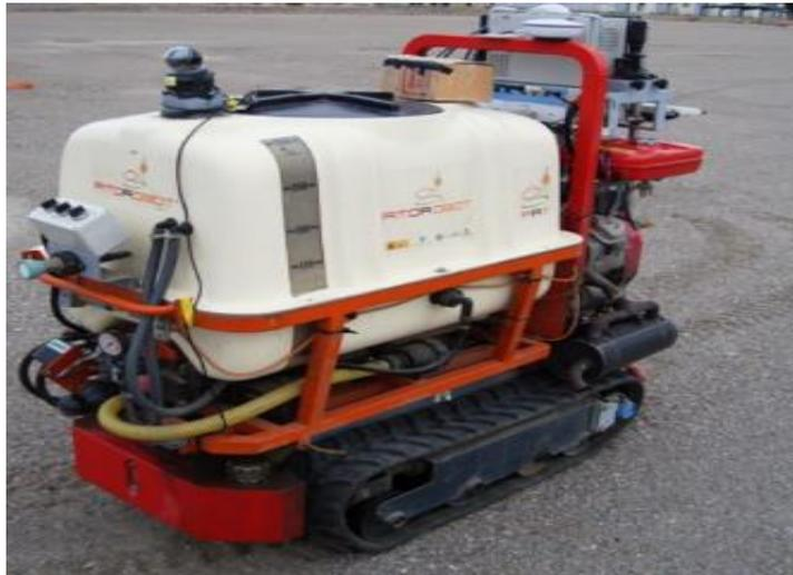
*Figura 3. Fitorobot: Robot móvil con sistema de locomoción mediante orugas de goma.*
