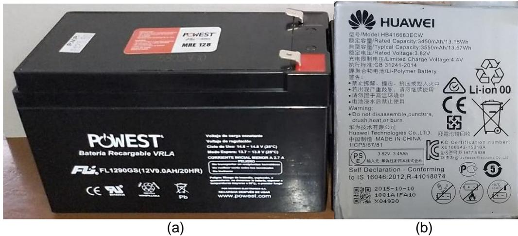
Figura 58. Baterías del prototipo. (a) Batería de plomo ácido de 12V/9Ah. (b) Batería de litio de 3.82V/3450mAh.
