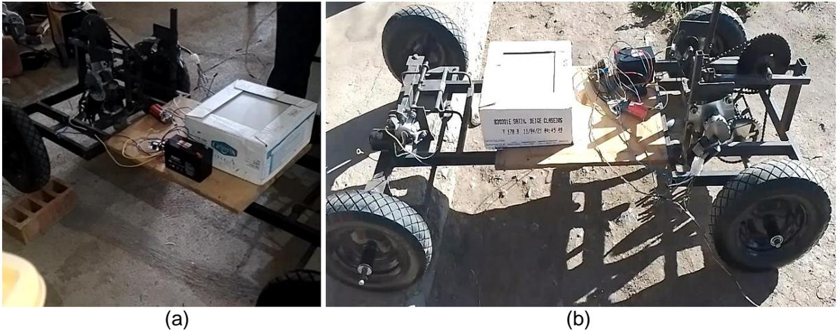
Figura 29. Pruebas de tracción del chasis de robot en suelo plano. (a) Prueba en concreto con carga de 25kg, la llanta sube un ladrillo. (b) Prueba en suelo de tierra con carga de 25kg, la llanta sube una grada de concreto.
