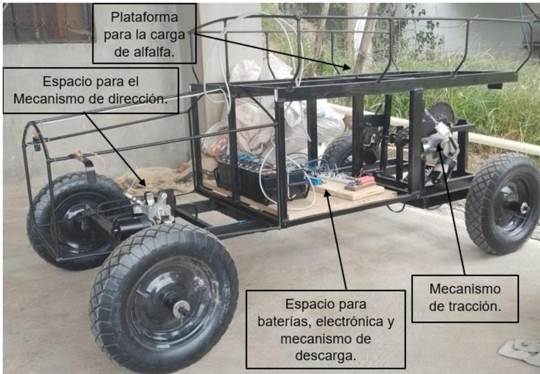
Figura 33. Carrocería del robot móvil para transporte de carga y distribución de sus componentes.
