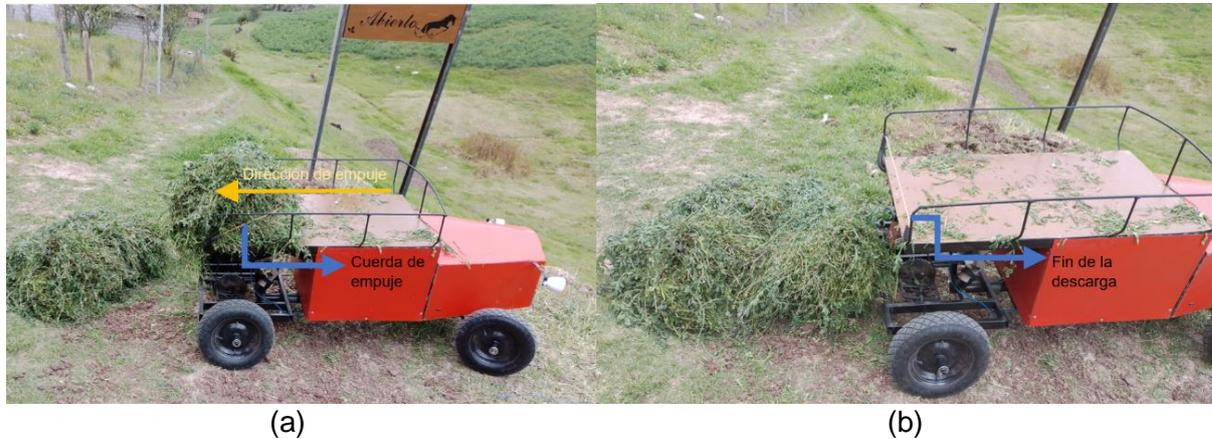
Figura 71. Descarga del robot. (a) Dirección de empuje de la cuerda. (b) Descarga completa del robot, cuerda enrollada.
