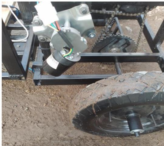
*Figura 32. Prueba de tracción del chasis en suelo húmedo.*
