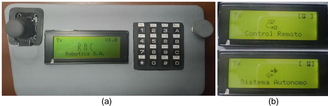
Figura 44. Control remoto. (a) Sistema control a distancia. (b) modos de uso.
