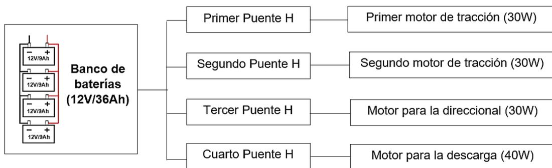
Figura 59. Etapa de potencia para motores.
