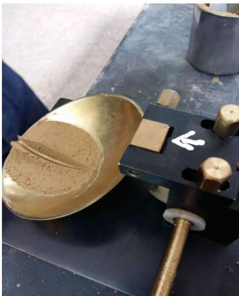
Fotografía 7. Determinación del límite líquido
