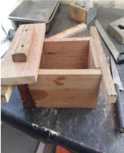
Fotografía 1. Moldes de madera para los ladrillos
