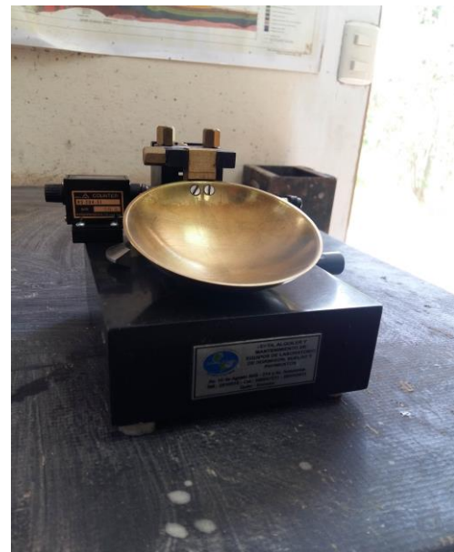
Fotografía 4. Cuchara de Casagrande para determinar el límite líquido
