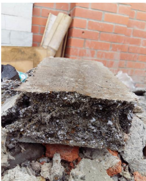
Fotografía 14. Ladrillo con 50% de papel curado en pileta, luego del ensayo
