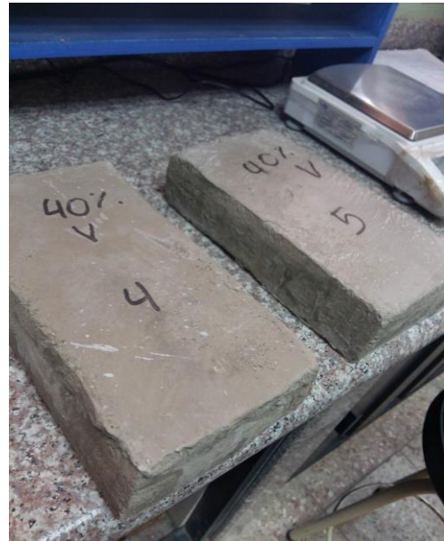
Fotografía 10. Ladrillos con 40% de viruta, sin curado en pileta
