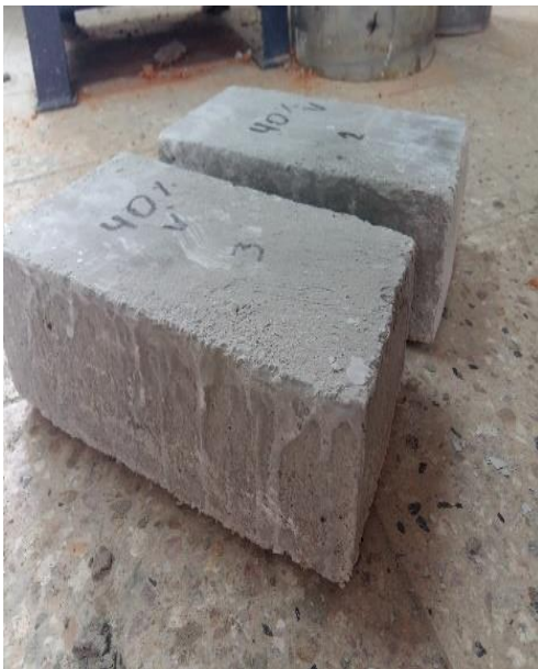
Fotografía 9. Ladrillos con 40% de viruta, con curado en pileta
