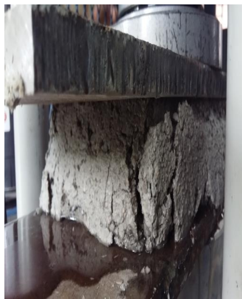
Fotografía 15. Ladrillo con 60% de papel curado en pileta, al momento de ser ensayado libera agua en exceso
