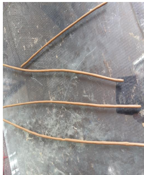
Fotografía 8. Determinación del límite plástico
