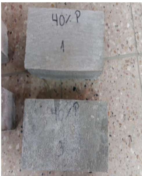
Fotografía 11. Ladrillos con 40% de papel, con curado en pileta
