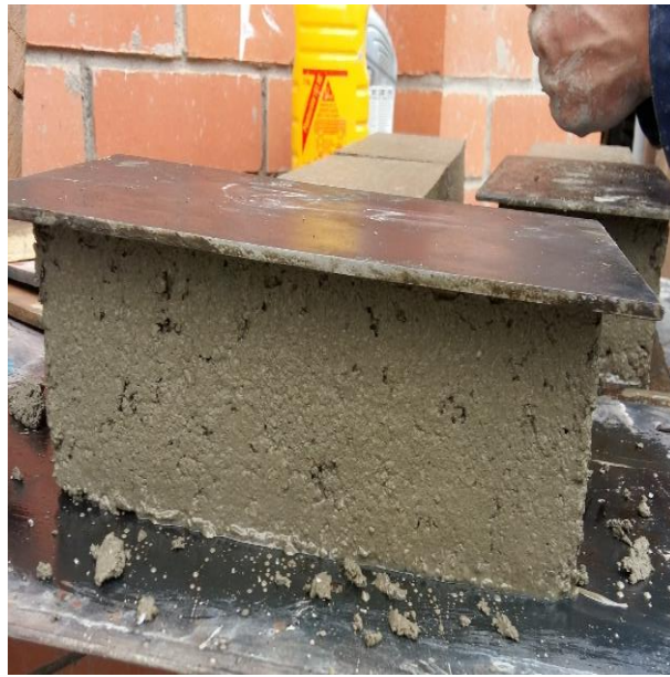
Ilustración 10. Ladrillos desmoldados con presencia de placa para nivelación. Fuente: Elaboración propia.
