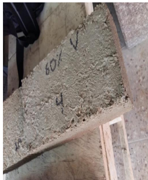
Fotografía 12. Ladrillos con 60% de viruta, sin curado en pileta
