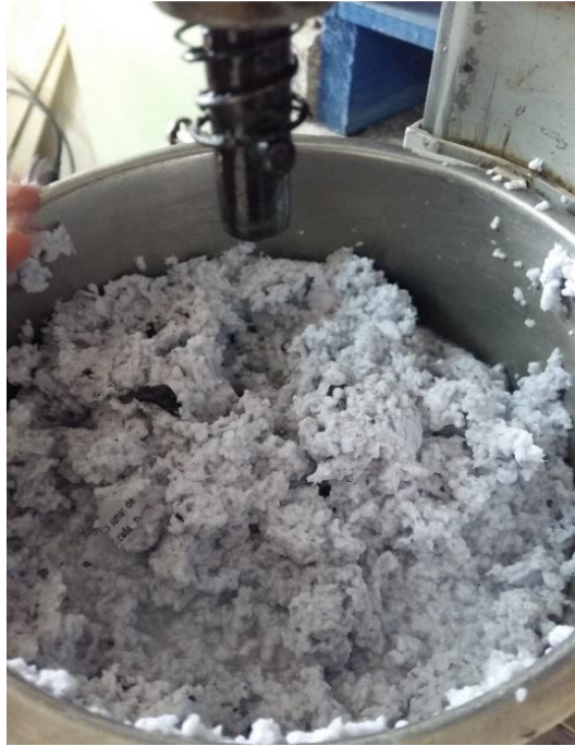
Ilustración 7. Homogenización del papel bond
