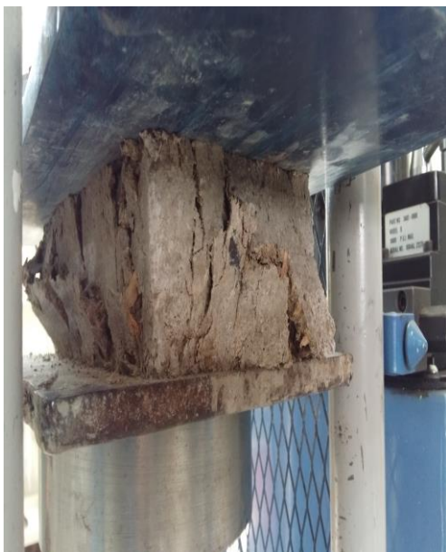
Fotografía 12. Ladrillo con 60% de viruta
