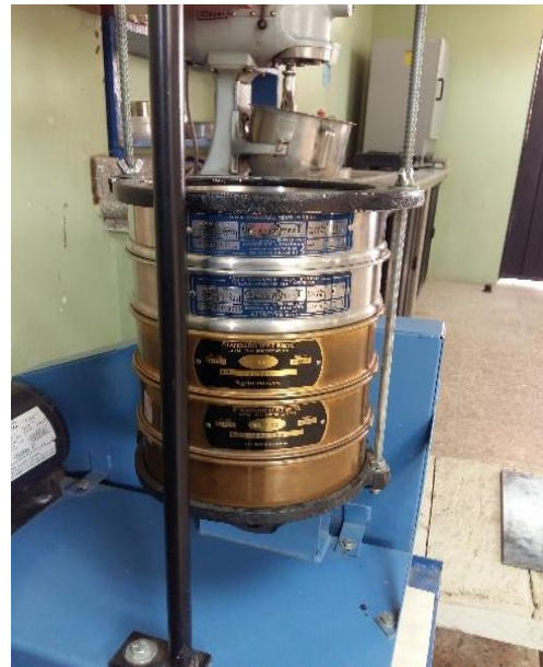
Fotografía 2. Tamices utilizados para granulometría
