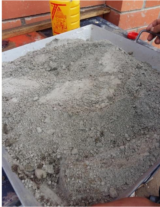
Ilustración 8. Mezcla en seco de cemento, suelo más arena Fuente: Elaboración propia.
