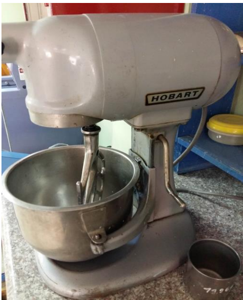
Fotografía 3. Batidora HOBART para homogenizar el papel
