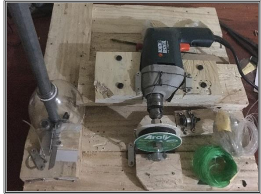
Máquina para extraer fibra (regular ancho y corte a longitud deseada)
