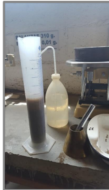
Prueba para determinar peso específico, absorción de la arena
