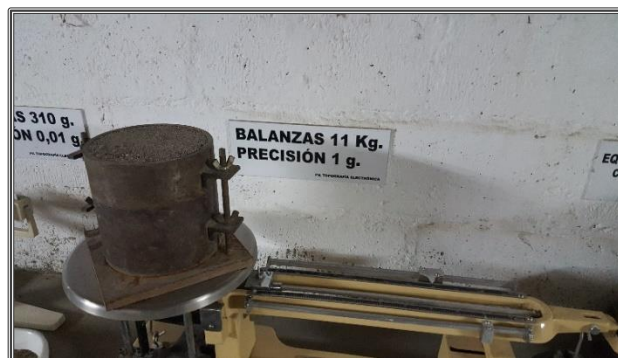
Prueba para determinar peso volumétrico
