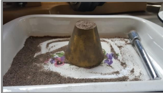
Toma y peso de muestra para granulometría de arena
