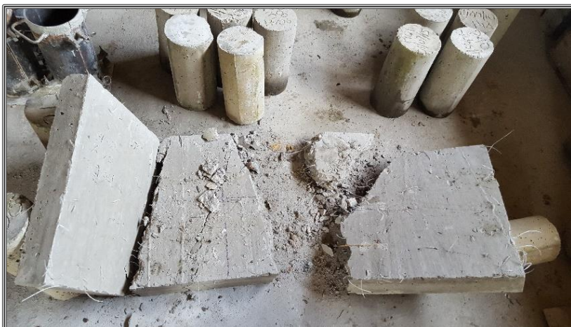
Prueba de losa con 0,6% de fibra de plástico
