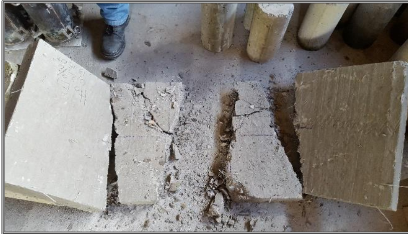
Prueba de losa con 0,2% de fibra de plástico
