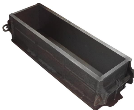
Ilustración 3.- Probeta prismática (15 cm de ancho por 15 cm de alto y 54 cm de largo)
