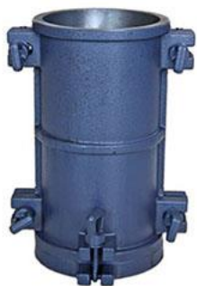
Ilustración 2.- Probeta cilíndrica (30 cm de alto y 15 cm de diámetro)
