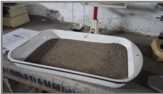
Prueba para de arena para determinar el estado de superficialmente saturado
