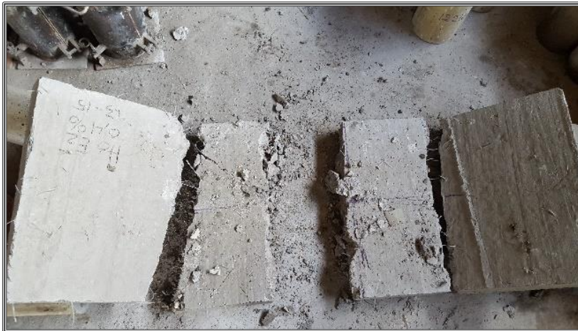
Prueba de losa con 0,4% de fibra de plástico
