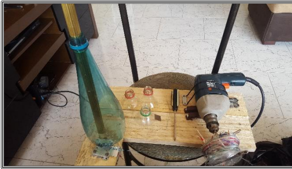
Máquina para extraer fibra (extrae la fibra y el corte de largo deseado se realiza a mano)
