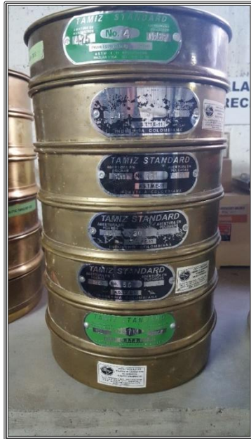
Tamices para las pruebas de granulometría
