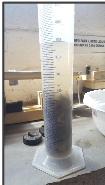
Prueba para determinar el peso específico y absorción de la grava
