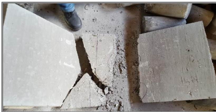
Prueba de losa con 0% de fibra de plástico
