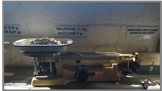
Toma y peso de muestra para granulometría de grava
