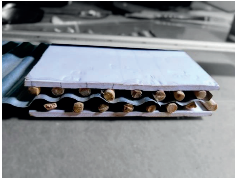
Imagen 70. Moldes de cubiertas
