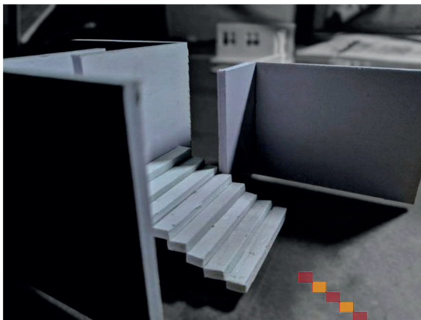
Imagen 63. Escaleras tiras con medias de huellas y contrahuellas
