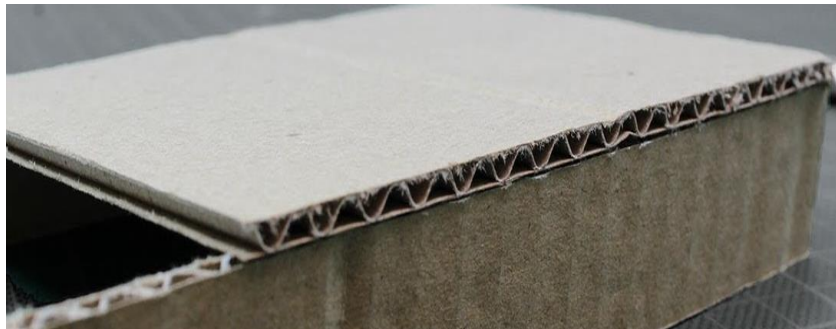
Ilustración 38. Adherencia del cartón corrugado.
