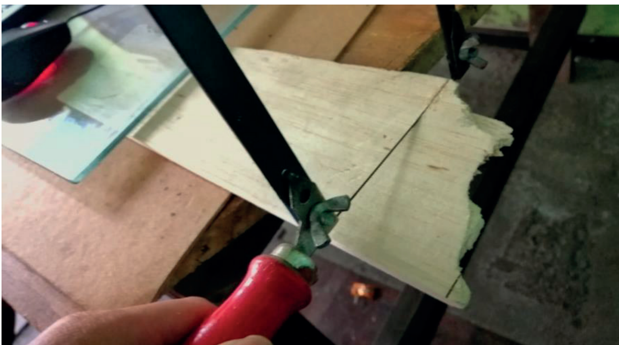
Imagen 41. Corte con sierra de maquetería
