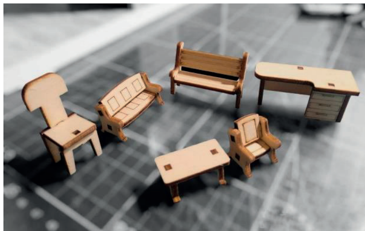
Imagen 86. Mobiliario mediante corte laser
