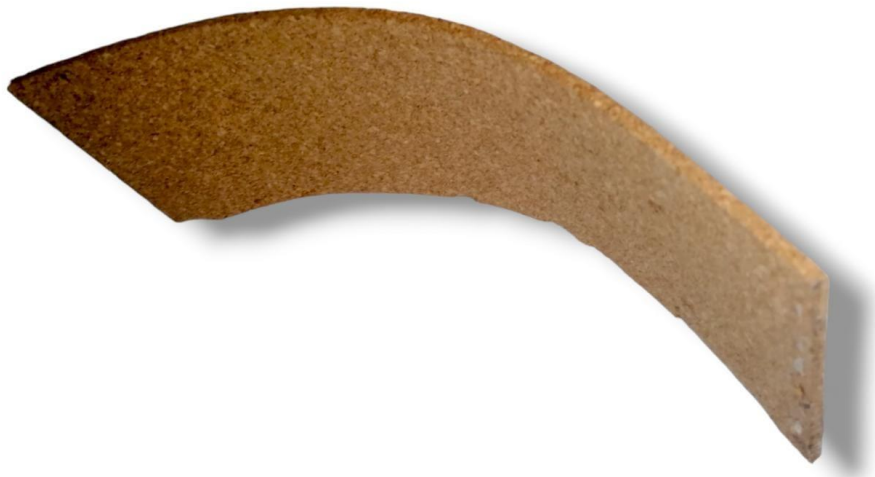
Ilustración 49. Flexibilidad del corcho
