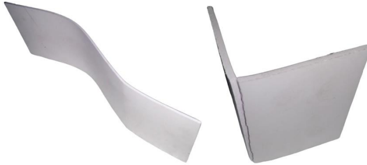
Ilustración 52. Flexibilidad del sintra
