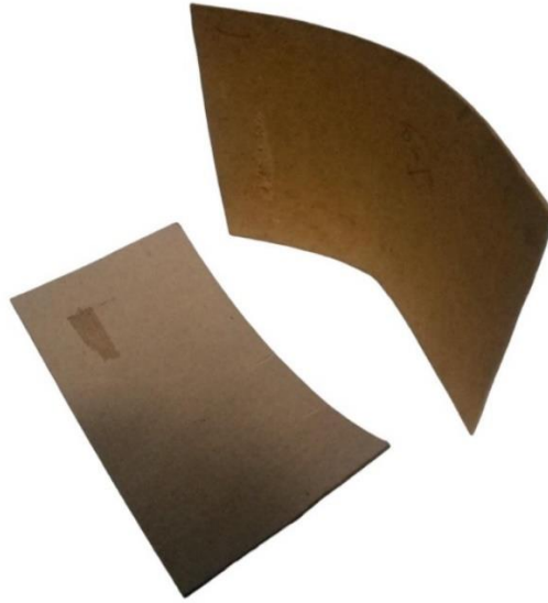
Ilustración 46. Flexibilidad del cartón prensado Fuente. Experimentación Elaboración. José Mesías Calle
