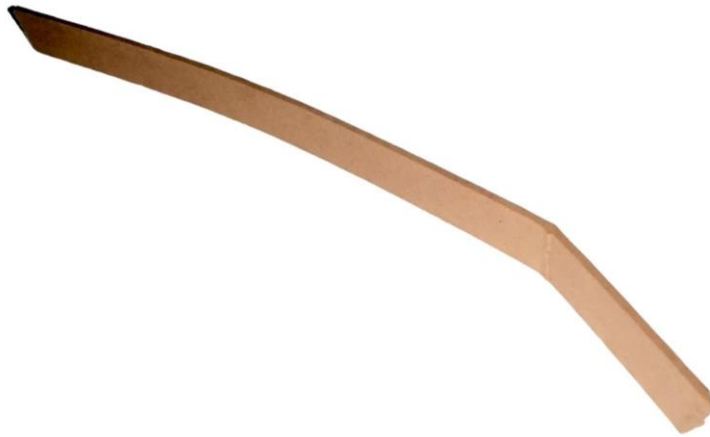
Ilustración 50. Flexibilidad del MDF.
