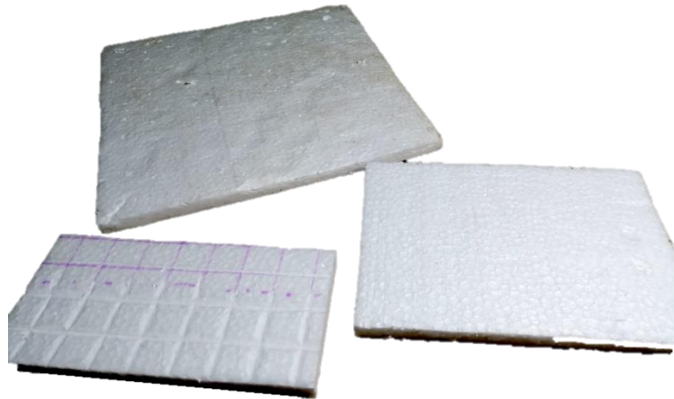
Ilustración 24. Espuma flex humedecido
