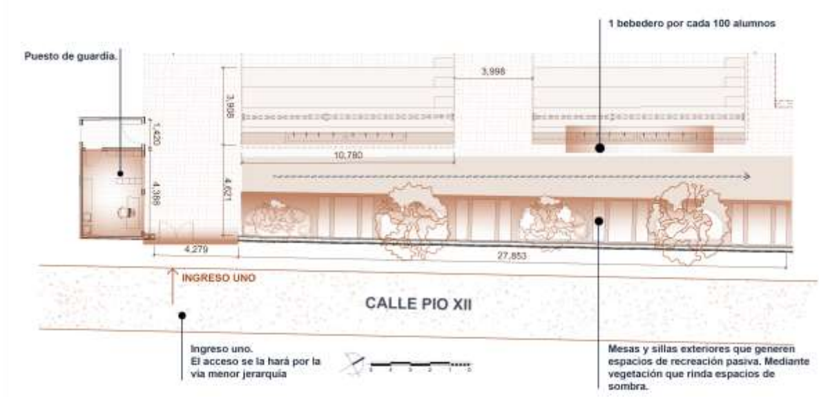
Figura 77: Planta a detalle ingreso uno.
