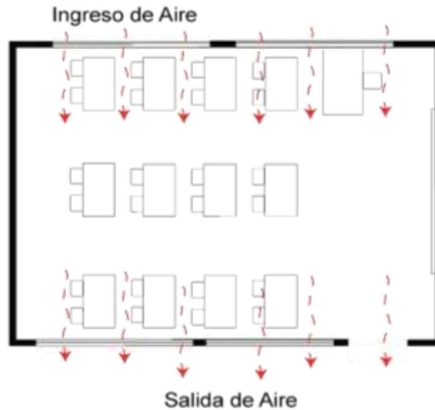
Figura 15: Condiciones de ventilación natural.
