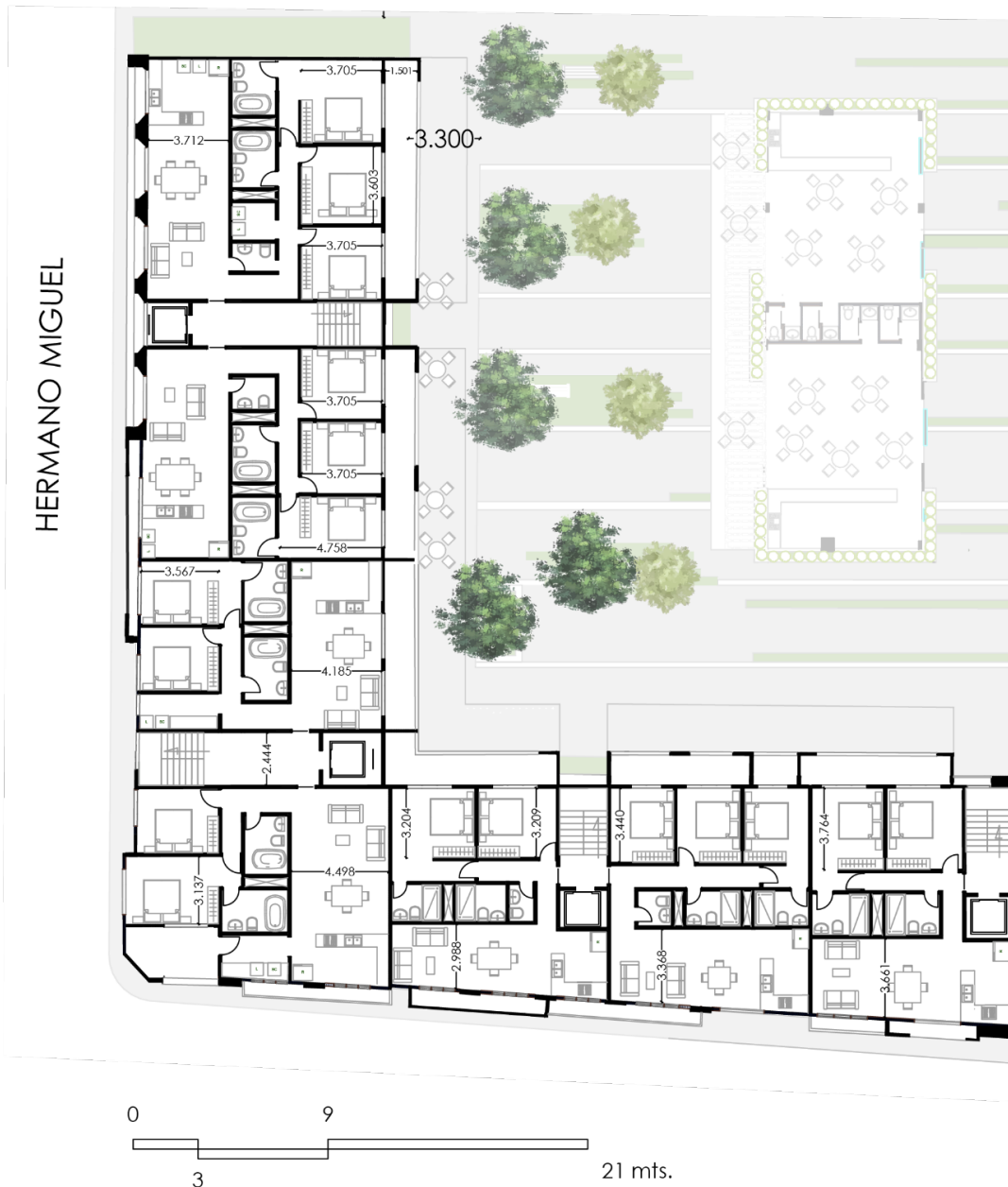
FIGURA 4.51: Propuesta Arquitectónica Planta nivel +3.00 abscisado Bloque 3 Fuente: Becerra, 2021
