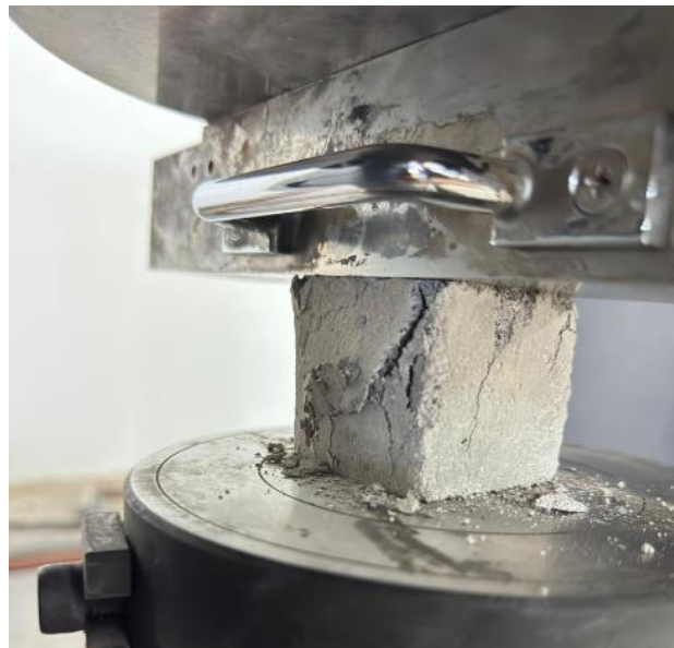
Figura 7 Rotura del cubo
