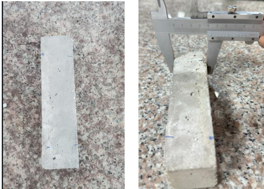
Figura 10 Viguetas de mortero
