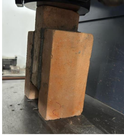
Ilustración 10 Ensayo de Adherencia-trio Modelo Patrón
