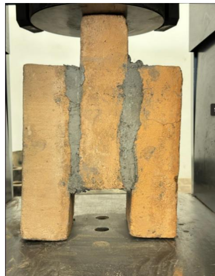
Ilustración 11 Adherencia trio a los 5-10 min en el horno
