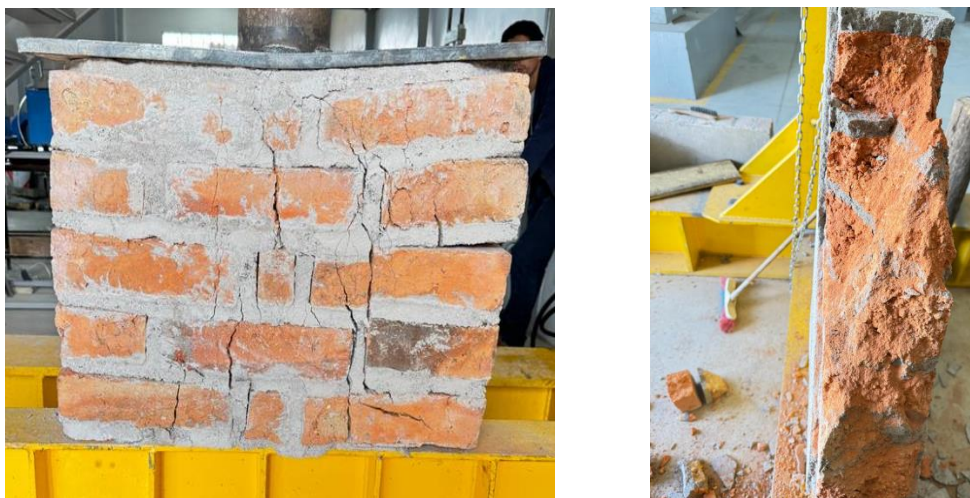
Figura 20 Paneles 15 min en el horno (1lado enlucido)
