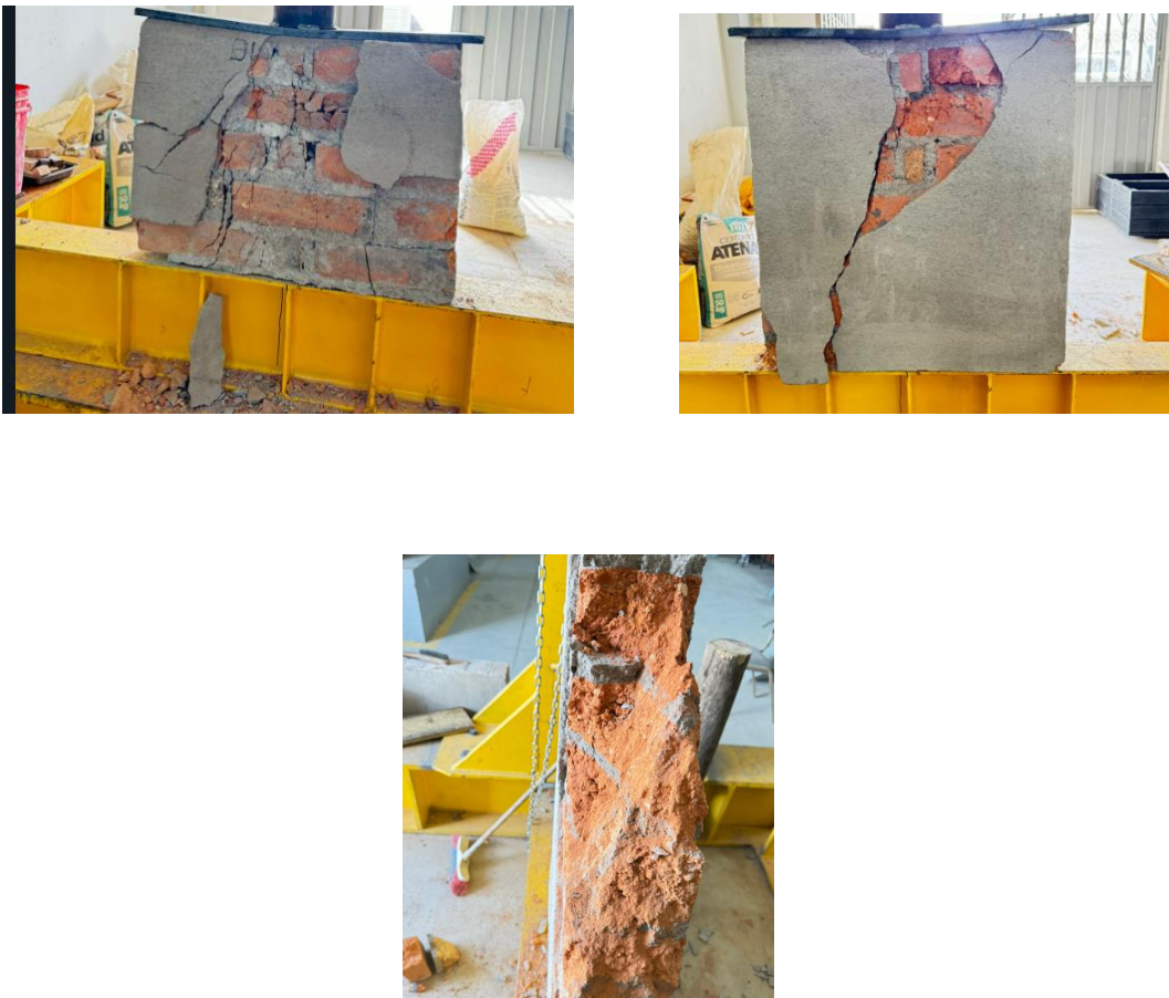
Figura 14 Paneles después del ensayo a compresión
