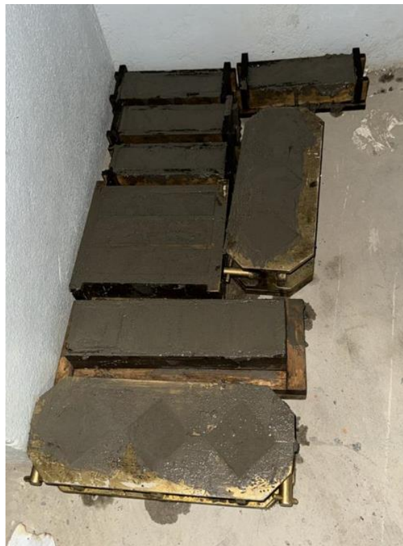
Figura 3 Mezcla de mortero para cubos y viguetas
