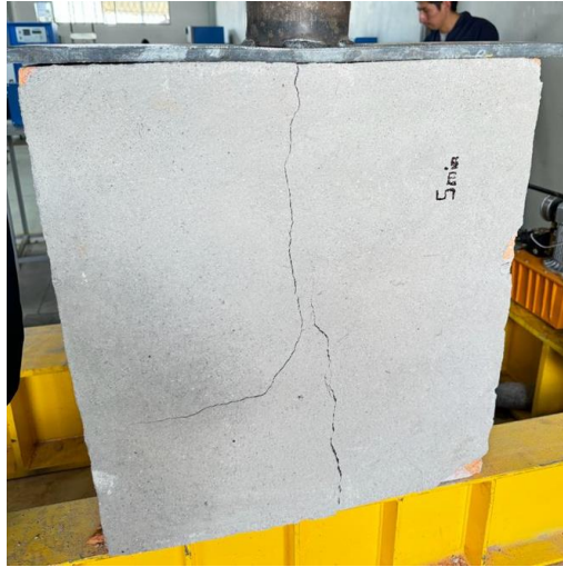
Figura 21 Panel 2 lados enlucido 5 min en el horno
