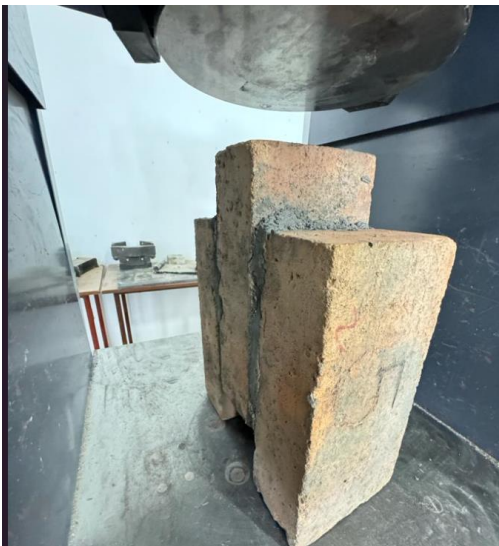
Ilustración 11 Adherencia trio a los 5-10 min en el horno
