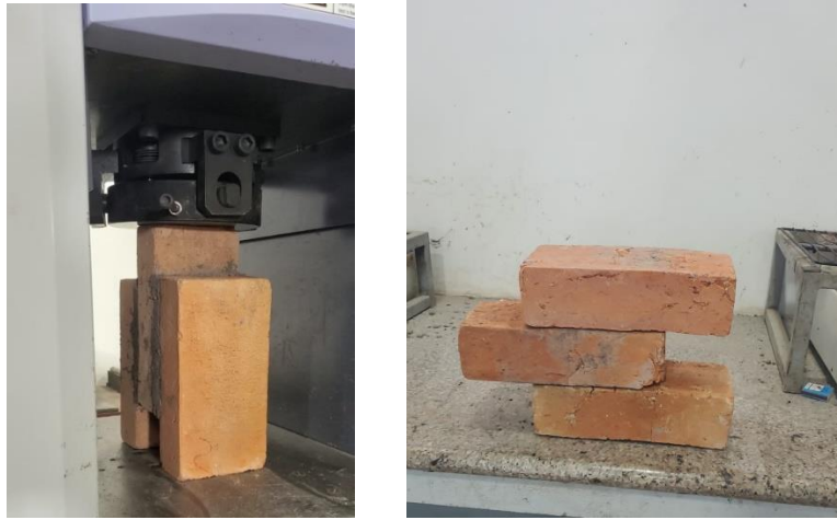
Figura 12 Trio de ladrillos y ensayo a compresión
