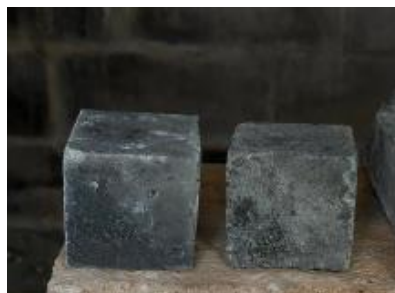
Figura 5 Cubos de 5x5x5 después del horno
