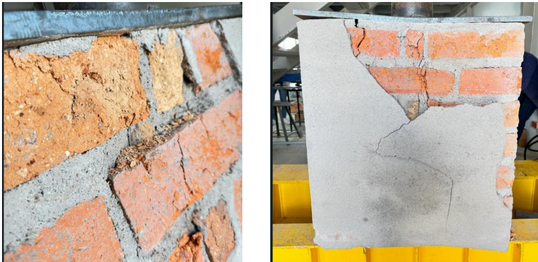
Figura 19 Paneles a los 10 min en horno (1 enlucido)
