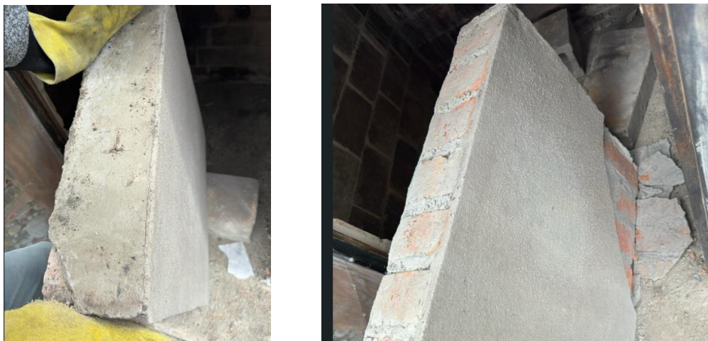
Ilustración 8 Panel después de 10min en el horno
