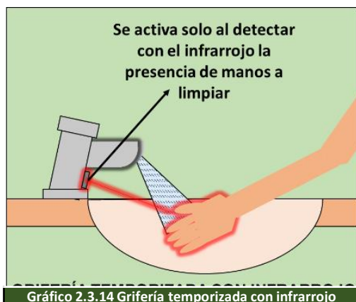
Gráfico 2.3.14 Grifería temporizada con infrarrojo
