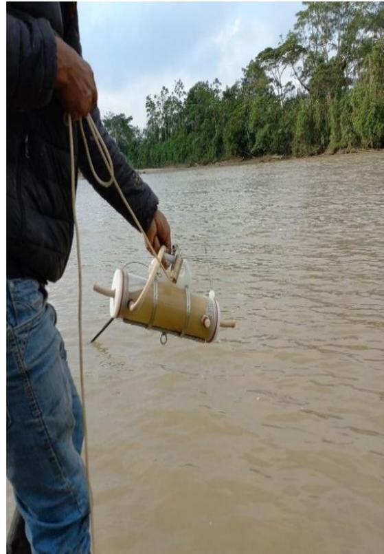
**Figura 21.** Turbidímetro
