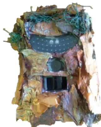
Figura 18: Carcasa para camuflaje y protección de humedad
