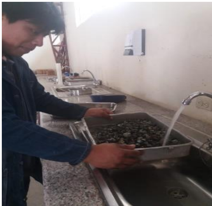
Ilustración 3.6 Lavado del árido después de las 500 revoluciones (Autor).
