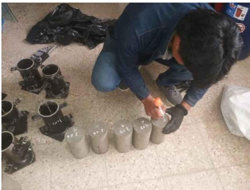
Ilustración 3.9 Desencofrado y enumeración de los cilindros (Autor).
