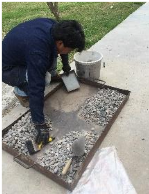
Ilustración 3.3 Reducción de la muestra a una cantidad de ensayo (Autor).
