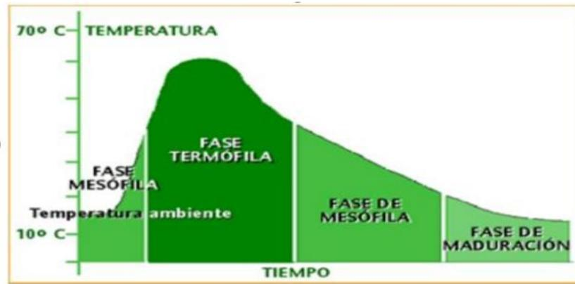
**Figura 1:** temperatura en cada fase del compostaje
