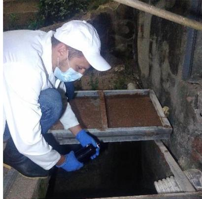
**Figura 24:** Toma de muestras de agua residual.
