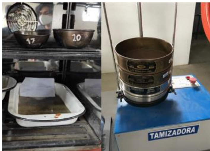
Secado de material en horno durante 24 horas y ensayo granulométrico
