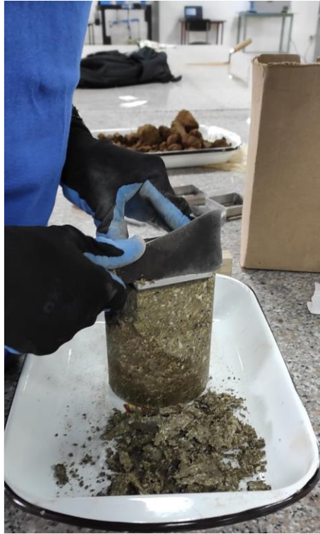
Tallado de muestra para ensayo de corte directo
