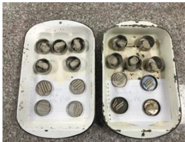
Límite plástico y límite líquido de las dos muestras de suelo
