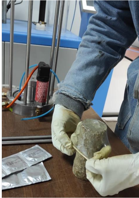
Impermeabilización de la muestra de suelo para ensayo triaxial
