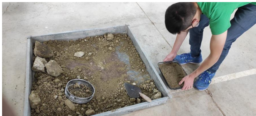
Material tamizados por el tamiz N°40 para ensayos de límites de Atterberg
