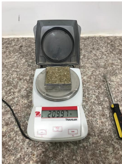
Determinación del peso de la muestra para ensayo de corte directo
