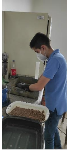
Preparación de muestra para compactación
