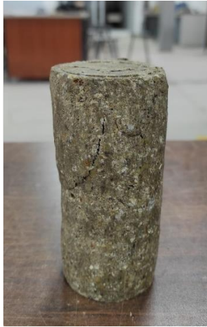
Muestra de suelo después del ensayo triaxial
