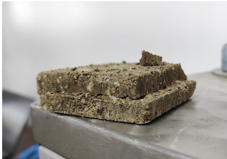
Muestra de suelo después del ensayo de corte directo
