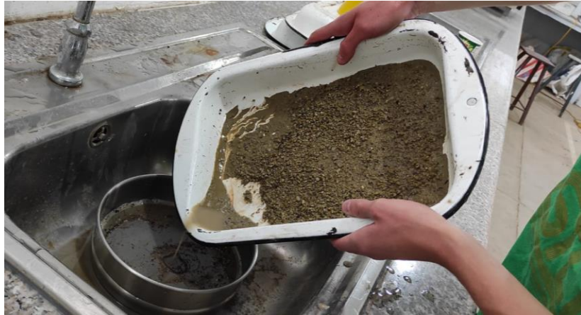
Lavado de material para ensayo granulométrico
