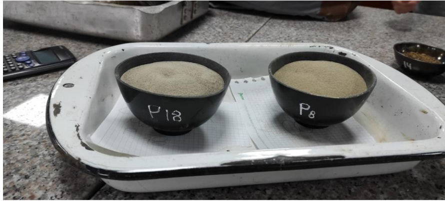
Muestras de suelo para ensayos de límites de Atterberg
