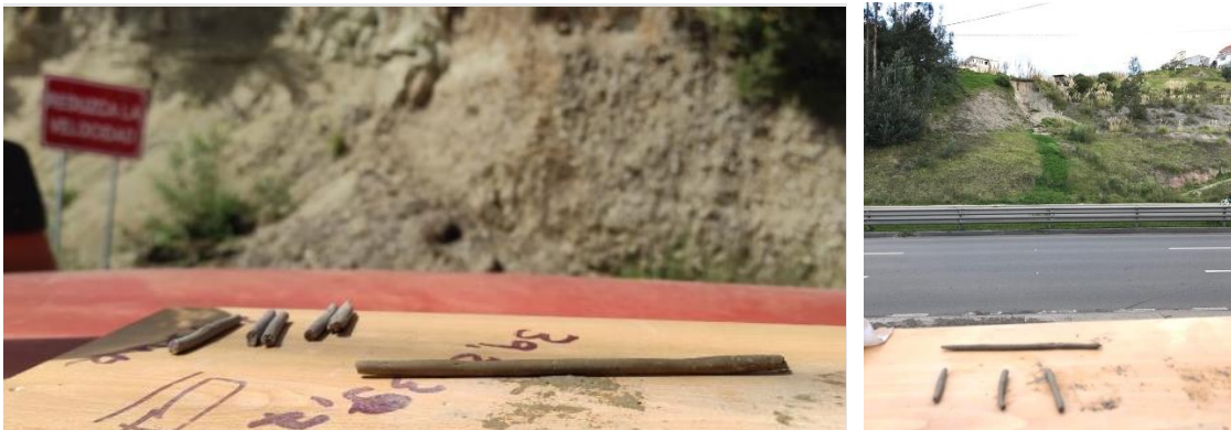
Prueba de plasticidad, técnicas instu
