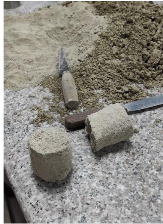
Muestra de suelo P18 presenta cohesión aparente, no es posible ensayo triaxial
