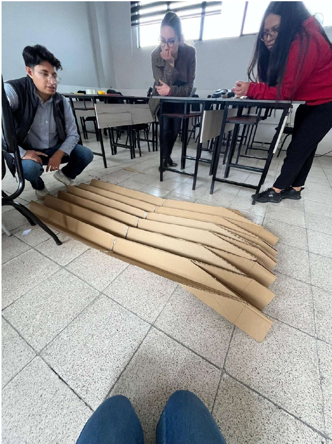
Figura 75: Prueba de campo y ensamblaje de prototipo a escala real. La imagen muestra la exploración de la rigidez estructural del cartón corrugado mediante el plegado longitudinal y la verificación de dimensiones espaciales. Fuente: Elaboración propia.
