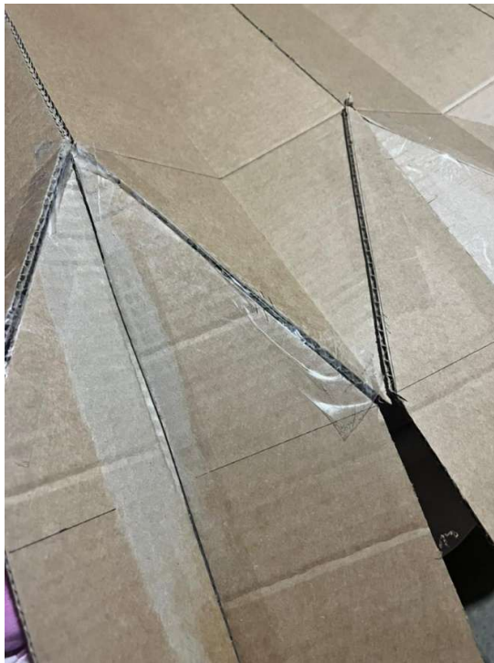
Anexo 13: Uniones del prototipo reforzadas con cinta de embalaje.
