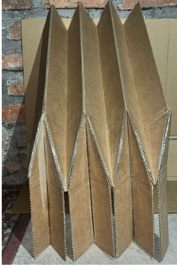
Anexo 13: Uniones del prototipo reforzadas con cinta de embalaje.
