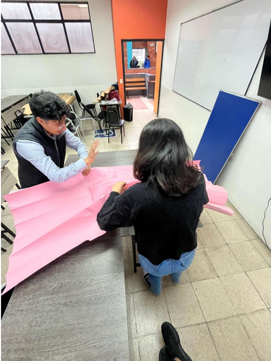
Figura 79: modelado de patrones de plegado a escala 1:1. El uso de modelos flexibles permite verificar la memoria del material y la facilidad de despliegue antes de pasar al cartón definitivo. Fuente: Elaboración propia.
