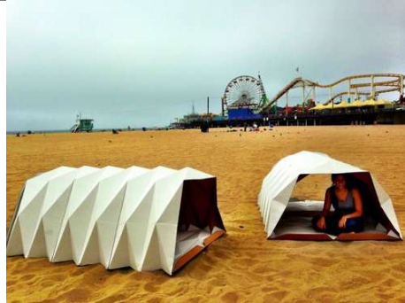
Figura 58: Prototipo de refugio temporal de cartón corrugado basado en principios de origami. Fuente: FEFOO
