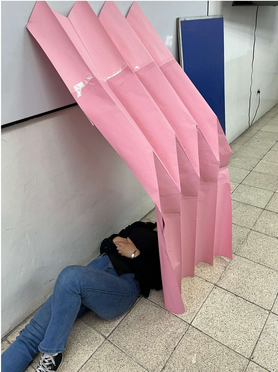
Figura 80: Validación del prototipo flexible en fase de experimentación. Se comprueba la capacidad del módulo para generar un espacio de resguardo autosoportante, adaptándose a las dimensiones del cuerpo humano en posición de descanso y demostrando la viabilidad del patrón de plegado. Fuente: Elaboración propia.
