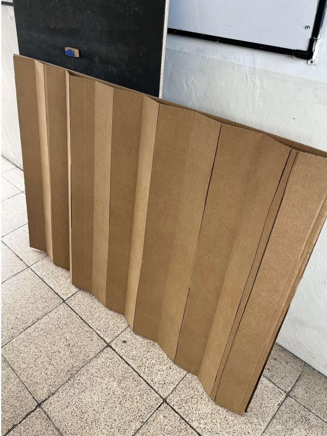
Figura 81: Validación estructural del módulo autoportante. El prototipo a escala real, fabricado en cartón corrugado, demuestra la rigidez lograda a través de la geometría de panal plegada (tipo origami), manteniéndose erguido y estable sin necesidad de soportes internos. Fuente: Elaboración propia.
