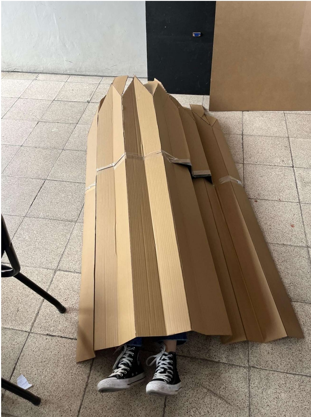
Figura 76: Verificación antropométrica del habitáculo en posición de descanso. La prueba permite validar la longitud y el volumen interno del refugio plegable, asegurando que las dimensiones del cartón cubran las necesidades mínimas. Fuente: Elaboración propia.
