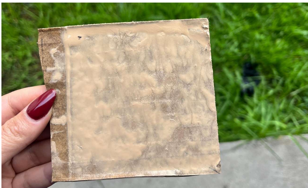
Figura 93: Resultados del ensayo de estanqueidad y resistencia hídrica. Tras la aplicación del sellante y la exposición a lluvia simulada, el cartón corrugado de doble onda mantuvo su integridad estructural sin presentar hinchamiento ni absorción por capilaridad, garantizando un interior seco. Fuente: Elaboración propia.
