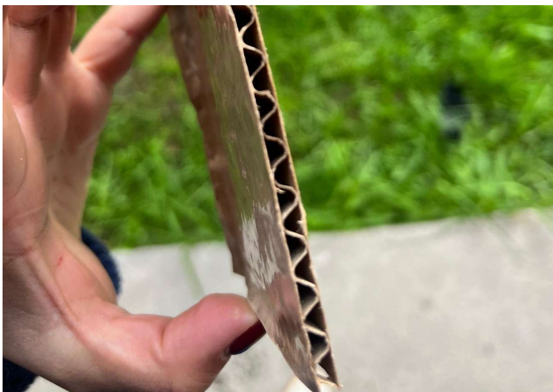
Figura 94 : Resultados del ensayo de estanqueidad y resistencia hídrica. Tras la aplicación del sellante y la exposición a lluvia simulada, el cartón corrugado de doble onda mantuvo su integridad estructural sin presentar hinchamiento ni absorción por capilaridad, garantizando un interior seco.
