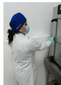
Colocar en la estufa las muestras a 35°C para los dos medios de cultivo CC - UTIC.
