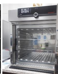
Colocar en la estufa las muestras a 35°C para los dos medios de cultivo CC - UTIC.
