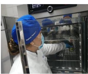
Colocar en la estufa las muestras a 35°C para los dos medios de cultivo CC - UTIC.
