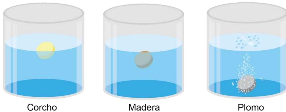
Fig. 27 Principio de Arquímedes (Autor)
