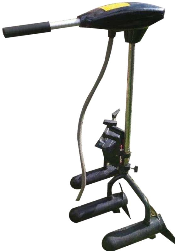
*Fig. 43 Propulsión Newport Vessels de 3 motores con cambio de velocidad (Autor)*
