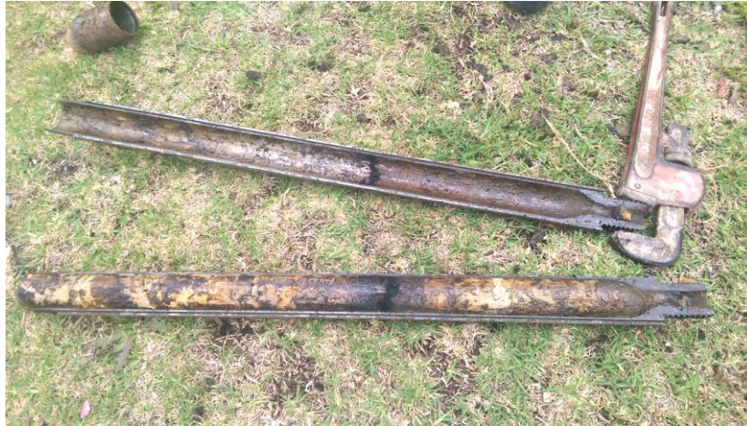
Foto 18: Muestreador tipo cuchara partida de 5 cm. de diámetro. Fuente propia.
