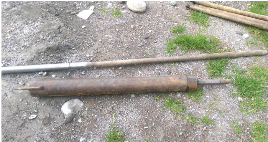
Foto 19: Martinete de 65 Kg. y la barra guía de acero. Fuente propia.
