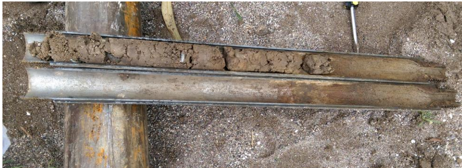
Foto 27: Muestra representativa hasta una profundidad de 3.50 m. Fuente propia.
