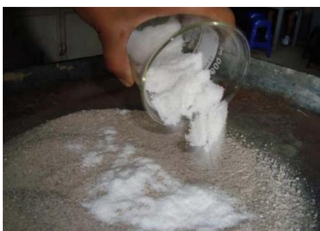
Ilustración 16: Aplicación de cloruro de sodio en forma de grano al suelo.
