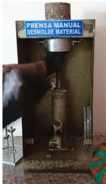
Ilustración 53 Prensa manual desmolde de material.
