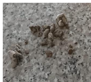
Ilustración 37: Formación de bolitas para realizar el ensayo de límite plástico.
