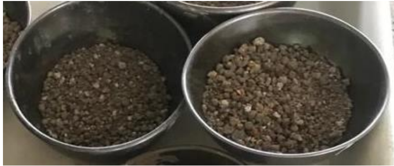
Ilustración 49 Obtención de las muestras para el cálculo de sus humedades respectivas.
