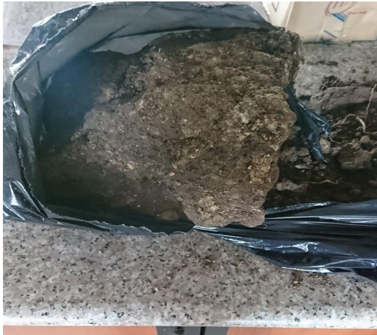
Muestra Inalterada Zona Paccha para ensayo de Corte Directo.
