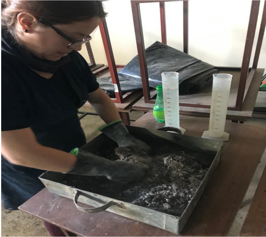
Mezclado de la muestra de suelo con Ceniza Volante.
