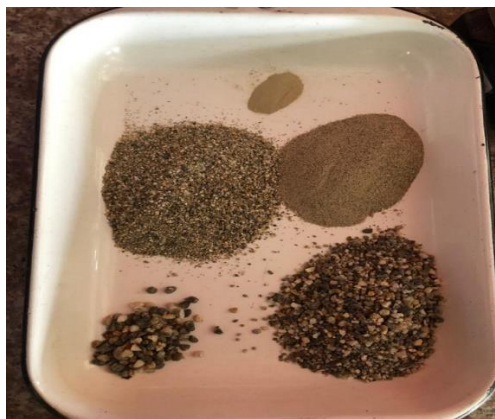
Ilustración 24: Retención del suelo por tamaños de partículas en los diferentes tamices.
