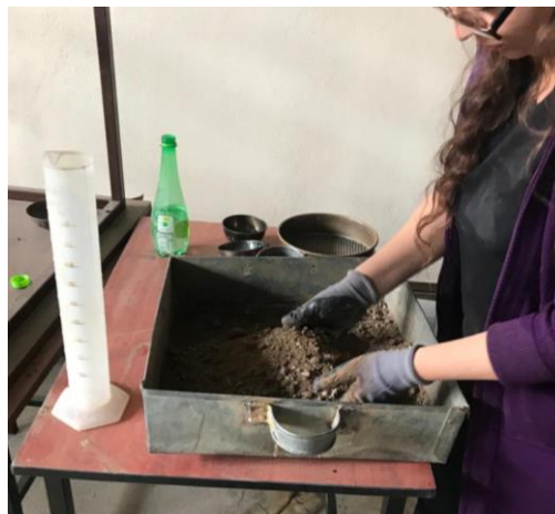
Ilustración 48 Mezclado de la muestra agua-suelo
