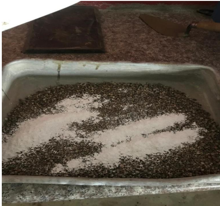
Mezcla de suelo estabilizado con Cal.
