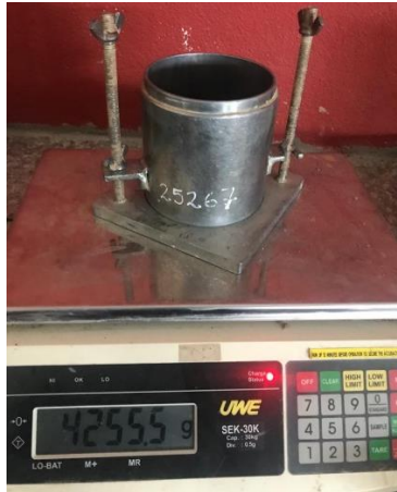
Ilustración 47 Determinación del peso del molde sin el collarín.
