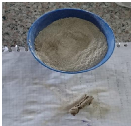
Ilustración 39: procedimiento del límite plástico estabilizado con cenizas volantes y cal.
