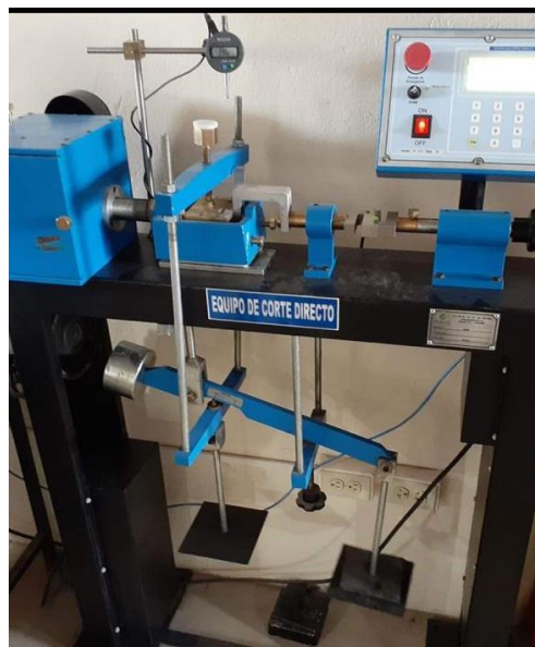
Ilustración 63 Equipo de Corte Directo con masa para ejercer la presión normal
