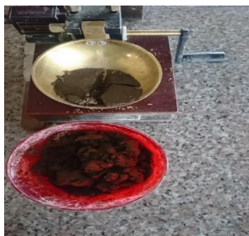
Ilustración 30: Ensayo del límite líquido con estabilización de Cloruro de Sodio.
