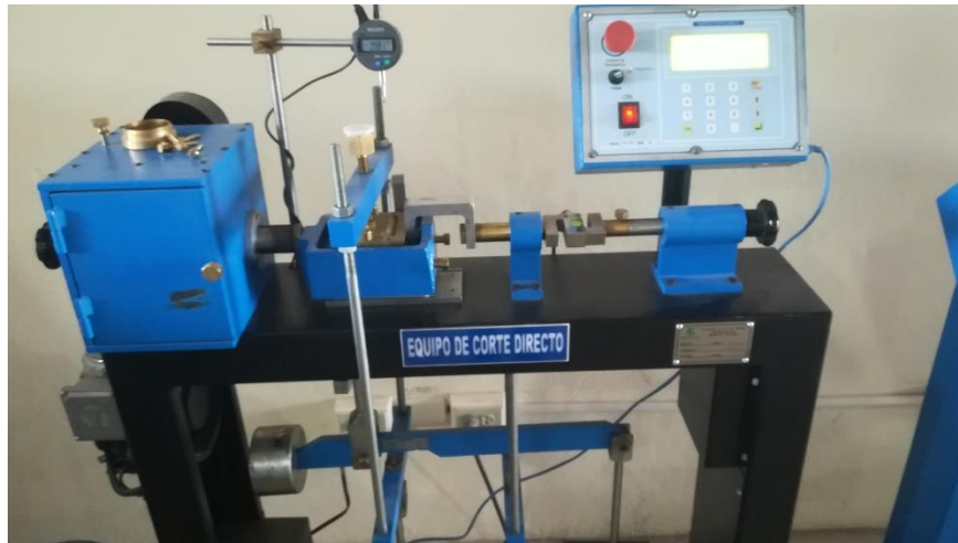
Ilustración 65 Equipo de Corte Directo ejecutando el ensayo.
