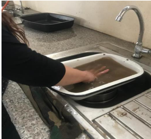
Ilustración 22. Lavado de material pasante tamiz No.4.
