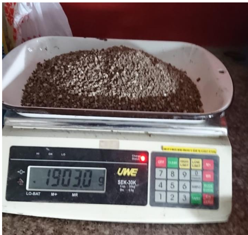
Preparación de la muestra con Cal 7% para ensayo de compactación
