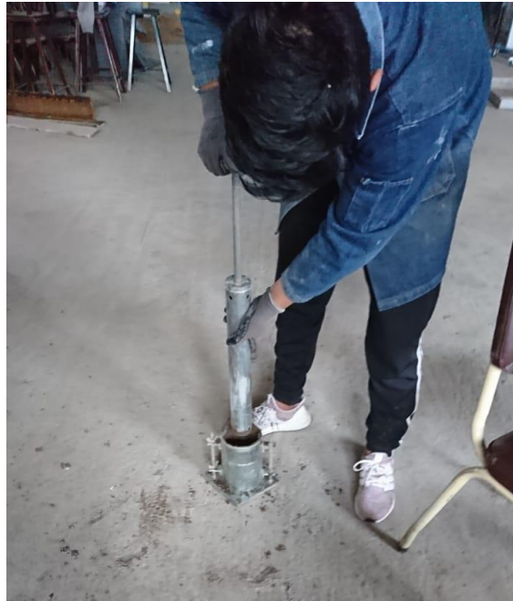
Ilustración 51 Ejecución del ensayo Proctor estándar
