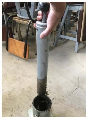
Ilustración 54 Compactación de la muestra 4 con un alto contenido de agua.
