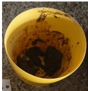
Ilustración 36: Muestra tomada del Límite Líquido cerrado a los 40 golpes.
