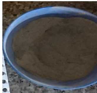
Ilustración 29: Muestra de suelo mezclada con cal y pasada a través del tamiz No. 40.
