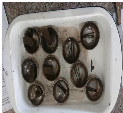
Ilustración 40: Muestras de Limite Liquido y del Limite plástico.
