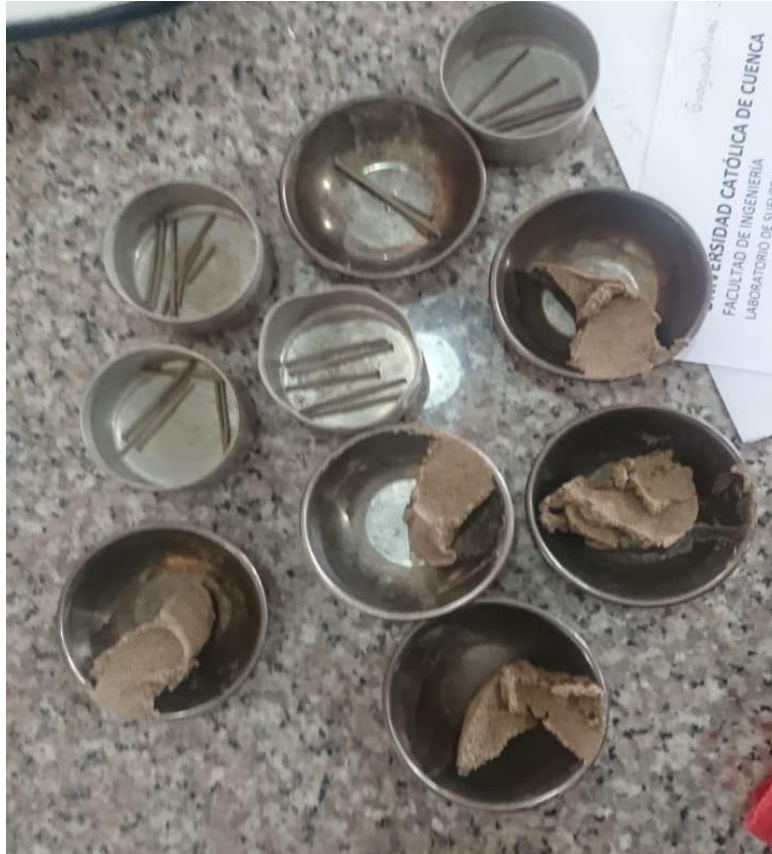
Muestras de Ensayos de Limites de Atterberg Cal 3%.
