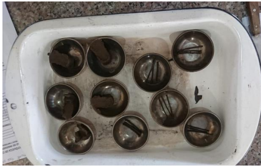
Ilustración 38: Muestras salidas del horno estabilizadas con cloruro de sodio, Limite líquido y limite plástico.
