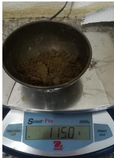
Ilustración 18: Determinación del Peso húmedo más el tarro para la determinación del contenido de humedad natural del suelo.
