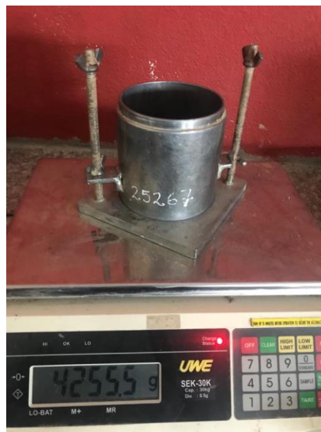
Ilustración 52 Pesado de la muestra compactada sin su collarín.
