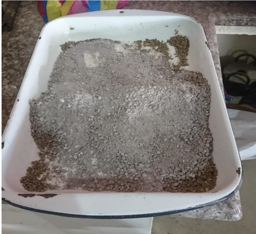
Muestra con Cal 12% para ensayo de compactación.
