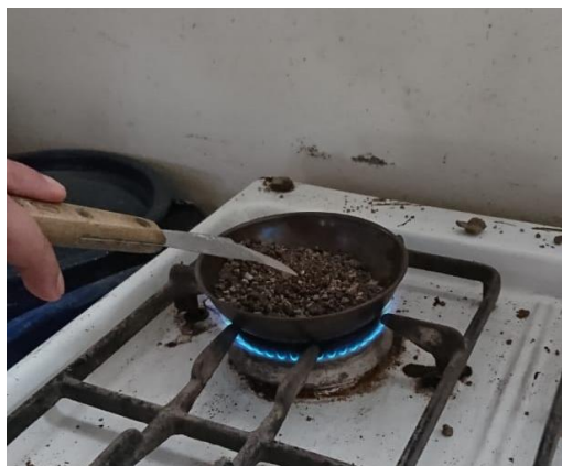
Ilustración 46 Secado de la muestra
