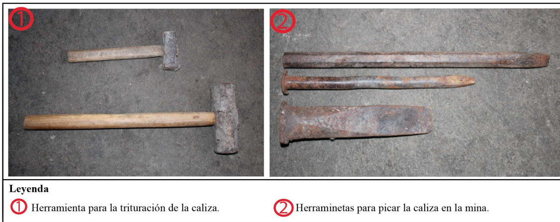
Imagen N. 8: Herramientas utilizadas para la producción de cal de forma artesanal.
