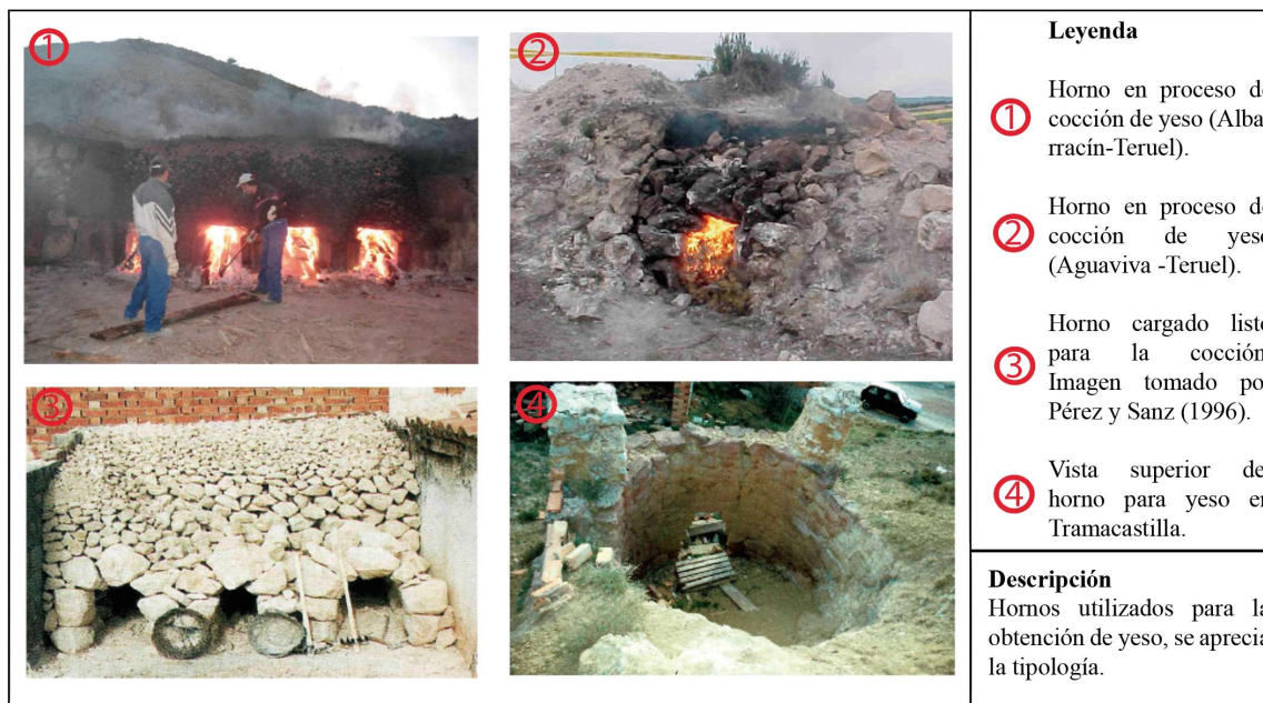
Imagen N. 17: Hornos para la elaboración de yeso
