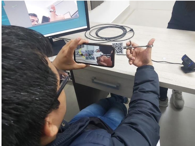
Figura 18: Verificación de la lectura del disparador de la jeringa en la app del celular.
