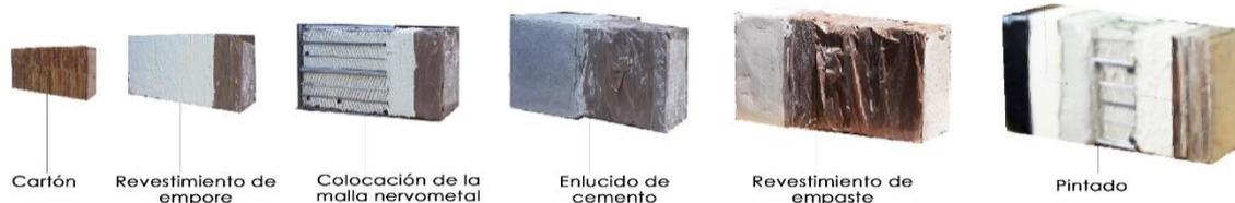
Ilustración 42, Calle S, (2018) Etapas de impermeabilización al ladrillo de cartón, (Imagen).
