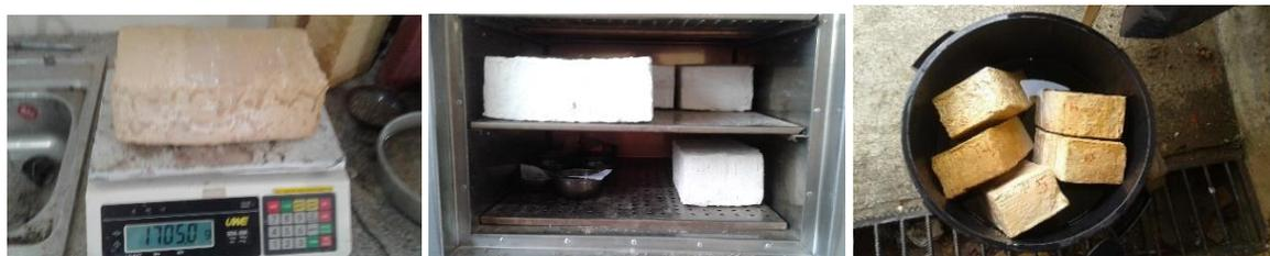
Ilustración 41, Calle S, (2018) Pruebas de laboratorio – Norma NTE INEN 296 – Determinación de absorción de humedad, (Imagen).
