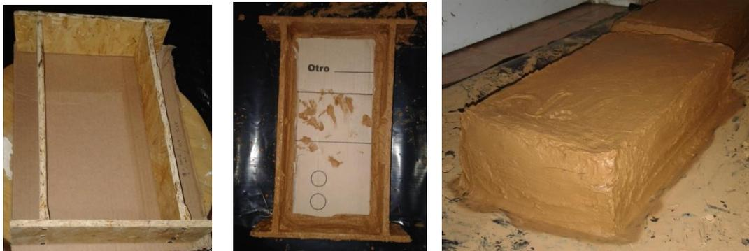
Ilustración 25, Calle S, (2017) Fabricación del ladrillo de cartón – acabado final, (Imagen).
