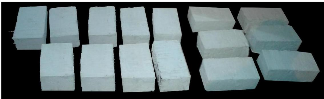
Ilustración 38, Calle S, (2017) Ladrillo de cartón + revestimiento de empore y poliacetato de vinilo, (Imagen).
