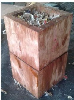
Ilustración 28, Calle S, (2017) Compactación de los prototipos de cartón - cofres, (Imaen)
