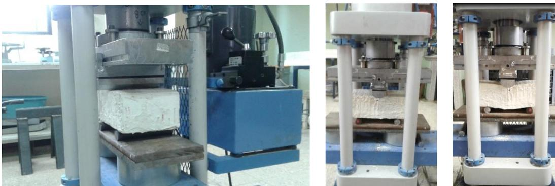
Ilustración 40, Calle S, (2018) Pruebas de laboratorio – Norma INEN 295:1977, Determinación de la resistencia a la flexión, (Imagen).
