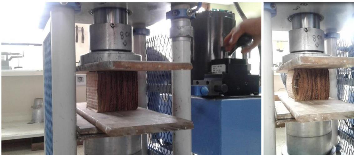
Ilustración 34. Calle S, (2017) Prototipos de cubo de cartón – Ensayos de compresión, (Imagen).
