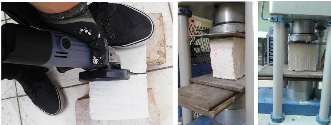
Ilustración 39, Calle S, (2018) Preparación de los ladrillos de cartón para la norma INEN 294 – Determinación de la resistencia a la compresión, (Imagen).
