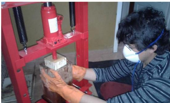
Ilustración 28, Calle S, (2017) Compactación de los prototipos de cartón, (Imagen).
