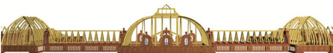
Figura 18 Estructura de madera de las cubiertas
