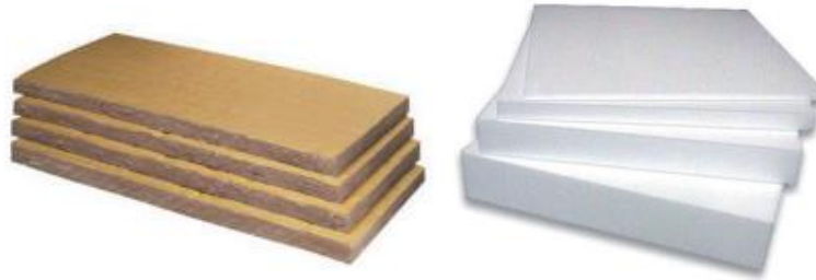
Figura 18: Materiales para aislamiento térmico. Lana de vidrio/ Poliestireno expandido Fuente: Ministerio de obras públicas
