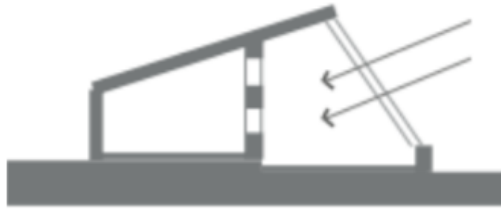
Figura 14: Ganancia solar aislada Fuente: Bibliocad. com
