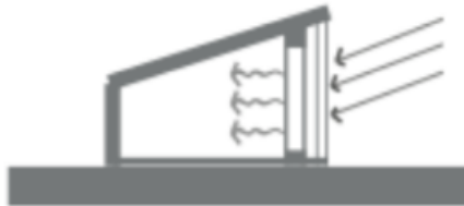
Figura 13: Ganancia solar indirecta Fuente: Bibliocad.com
