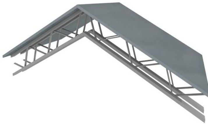
Figura 151. Cubierta con vigas de celosía Elaboración propia.
