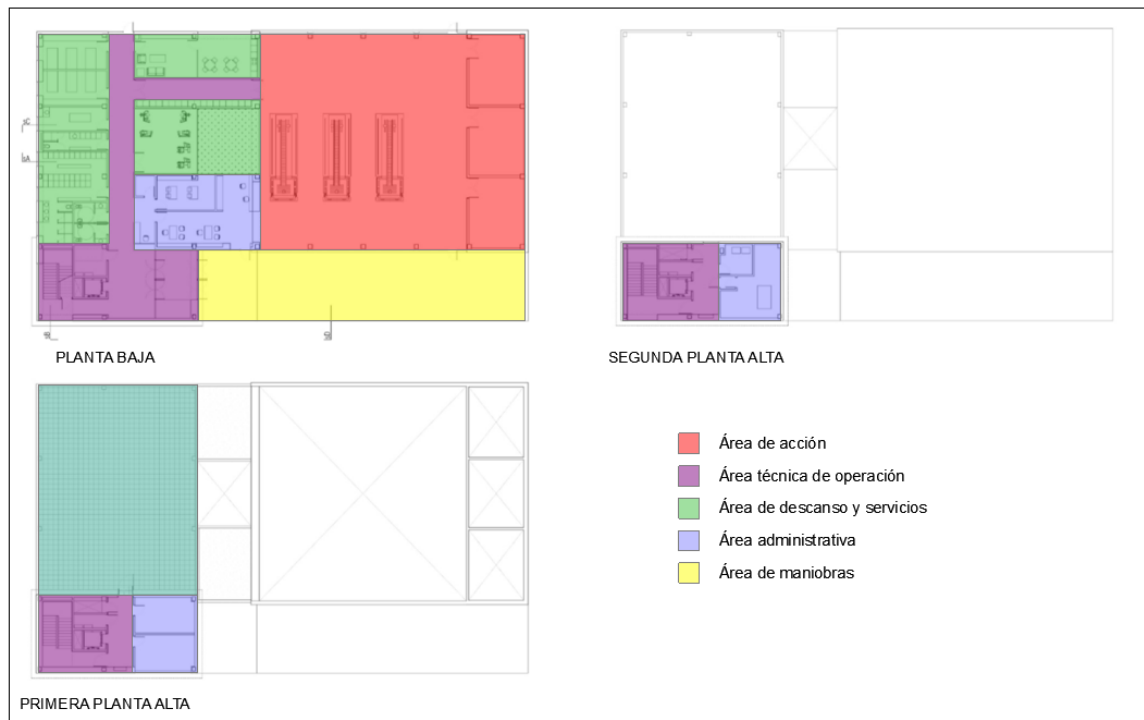
Figura 27. Respuesta espacial y funcional del Parque de bomberos N°4 de Zaragoza, España
