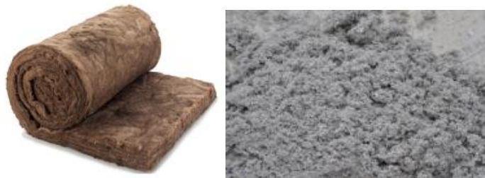
Figura 19: Materiales para aislamiento térmico. Lana mineral / Celulosa Fuente: Ministerio de obras públicas
