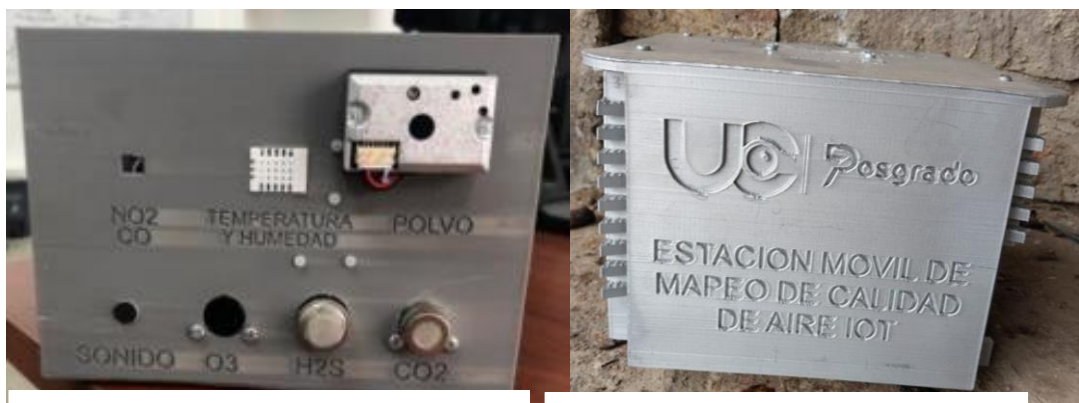
a) Equipo con los sensores electroquímicos de bajo costo.
