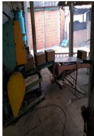
Figura 4: Corte de los ladrillos.
