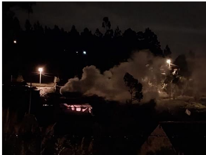
Figura 66: Emisión de gases durante la noche en la etapa de cocción de los ladrillos.
