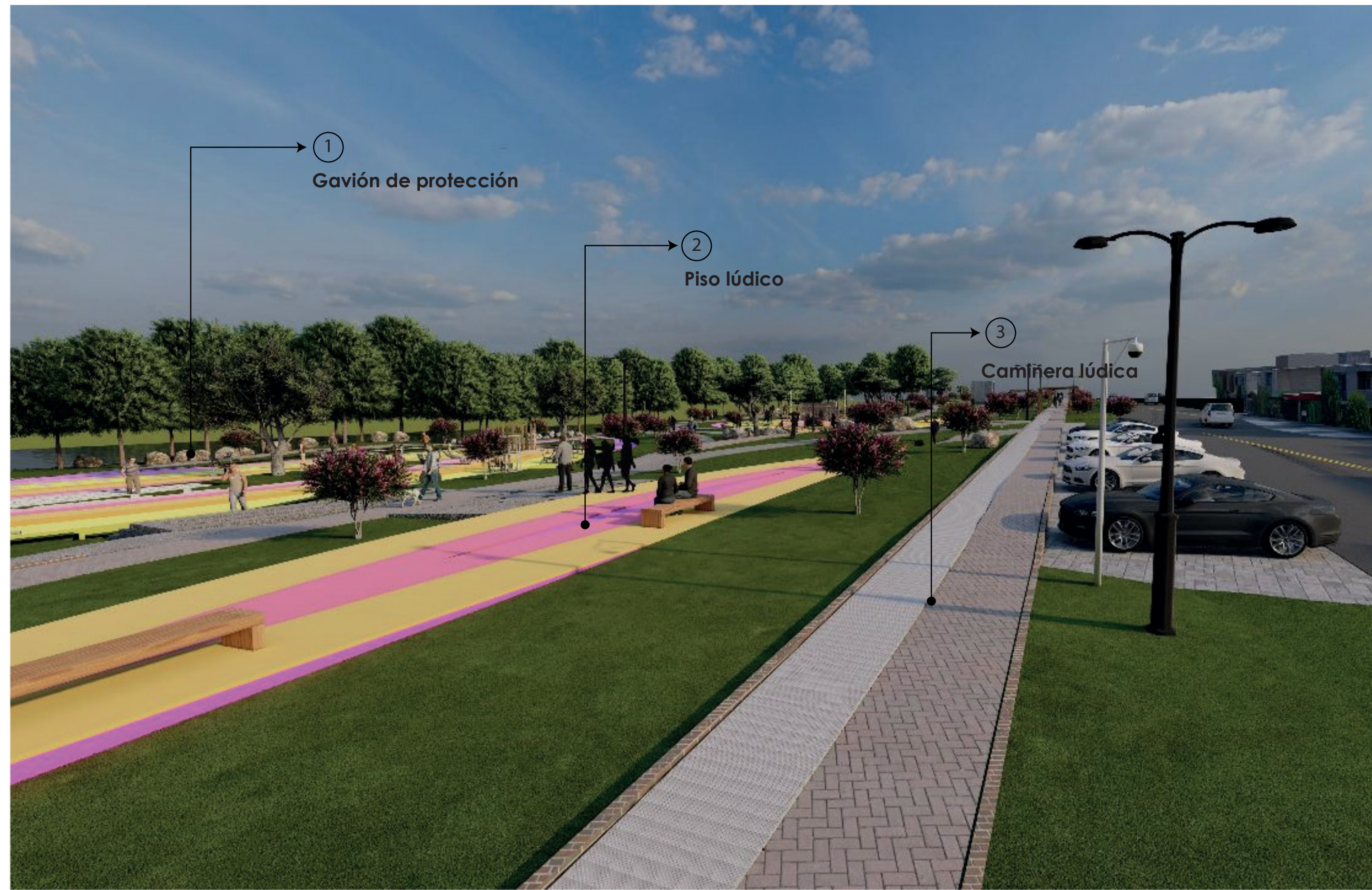
Se observa en la imagen la integración de camineras con doble textura, pisos lúdicos que constan de colores y de protección anticidas, y al filo del río Yanuncay se identifica la colocación de gaviones, los mismo que ayudan a la protección de inundaciones a causa del crecimiento del río.
