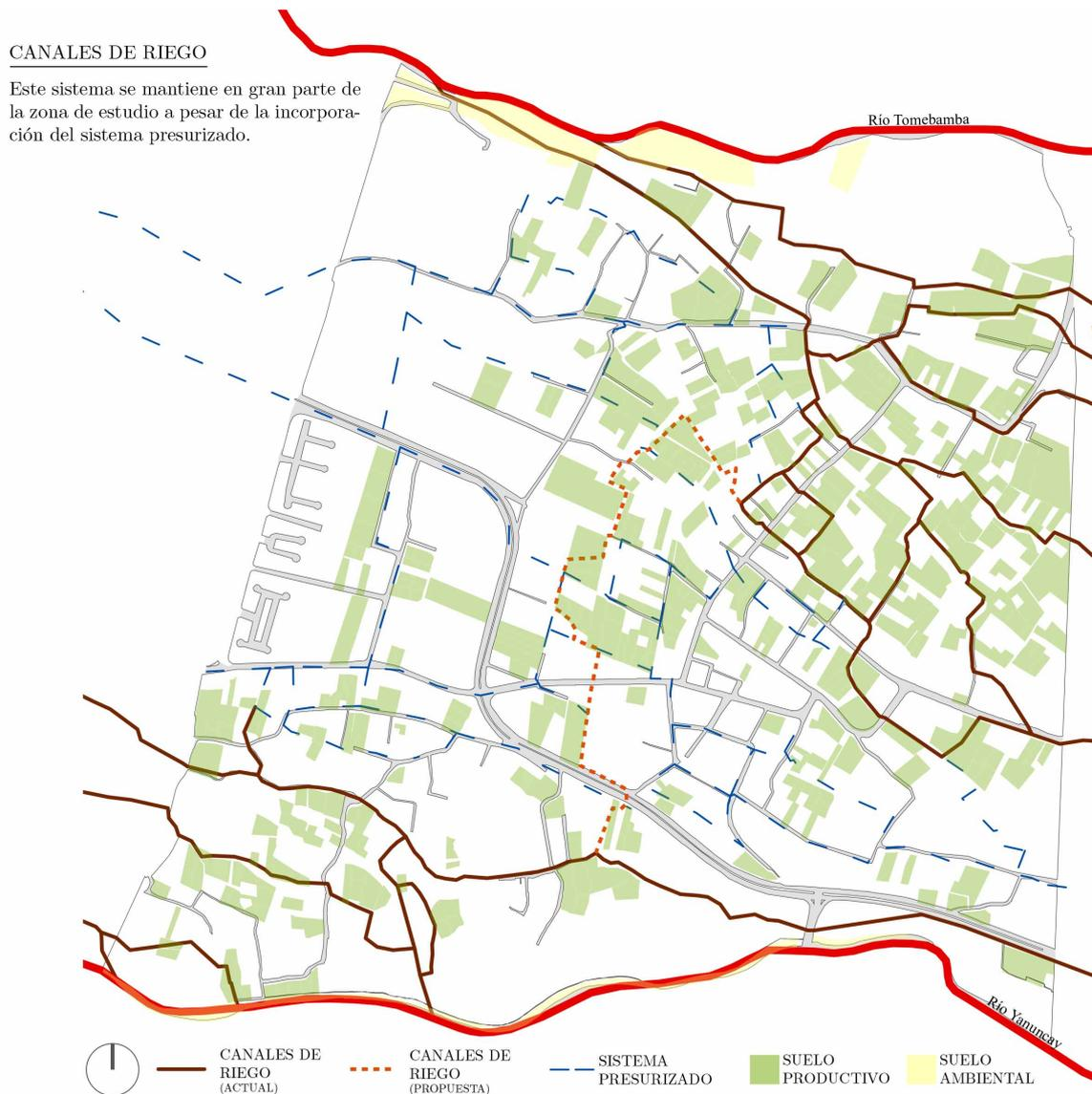
FIGURA 3.12: Canales de riego y sistema presurizado
