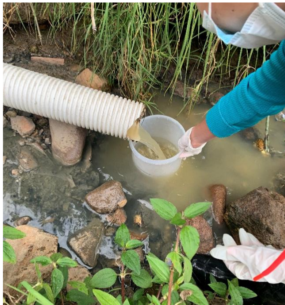
Ilustración 13: Método volumétrico para el cálculo del Caudal.
