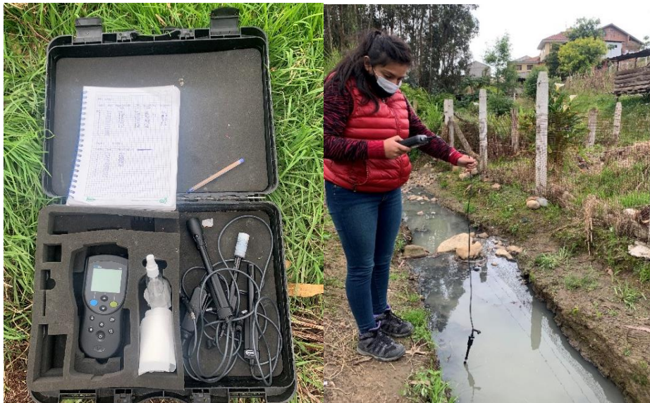
Ilustración 16: Análisis de agua in situ con equipo multiparamétrico.
