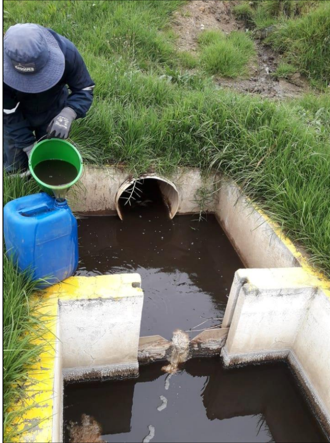
Figura 25: Toma de muestra de lixiviados previa entrada a la planta de tratamiento de lixiviados.
