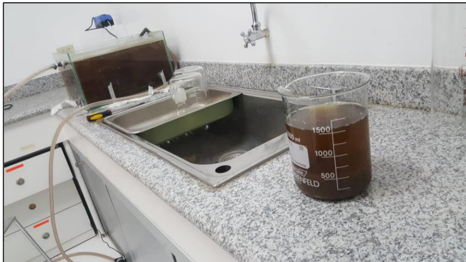
Figura 32: Vertido de lixiviado en el reactor biológico previo tratamiento fisicoquímico.
