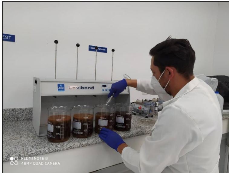
Figura 29: Proceso de Jar test. Adición de coagulante en las muestras de lixiviado
