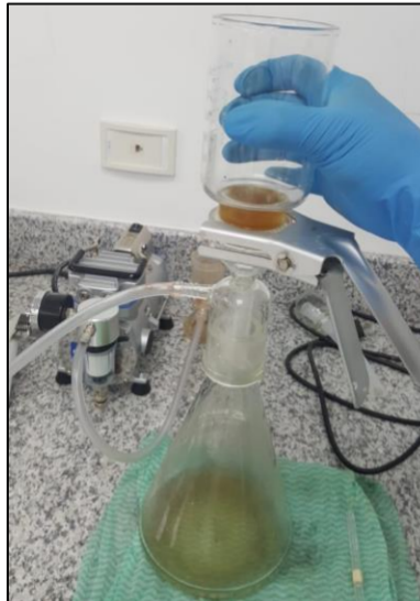
Figura 12: Bomba de filtración al vacío.
