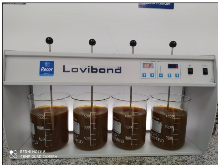
Figura 29: Proceso de Jar test. Adición de coagulante en las muestras de lixiviado
