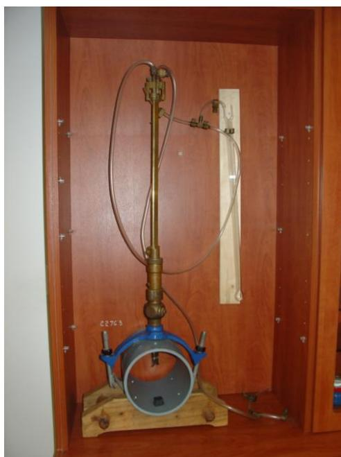
Figura 6: Medidor Diferencial "Tubo Pitot"
