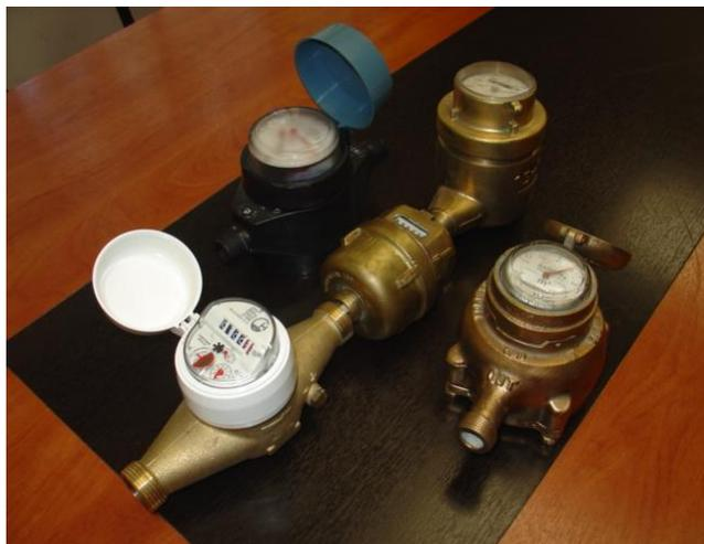
*Figura 8: Medidores de Agua Mecánicos*
