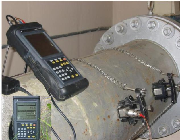
Figura 7: Medidor Especial "de Ultrasonido"
