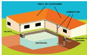
PROCESO DE RECOLECCIÓN DE AGUA LLUVIA MEDIANTE CUBIERTAS
