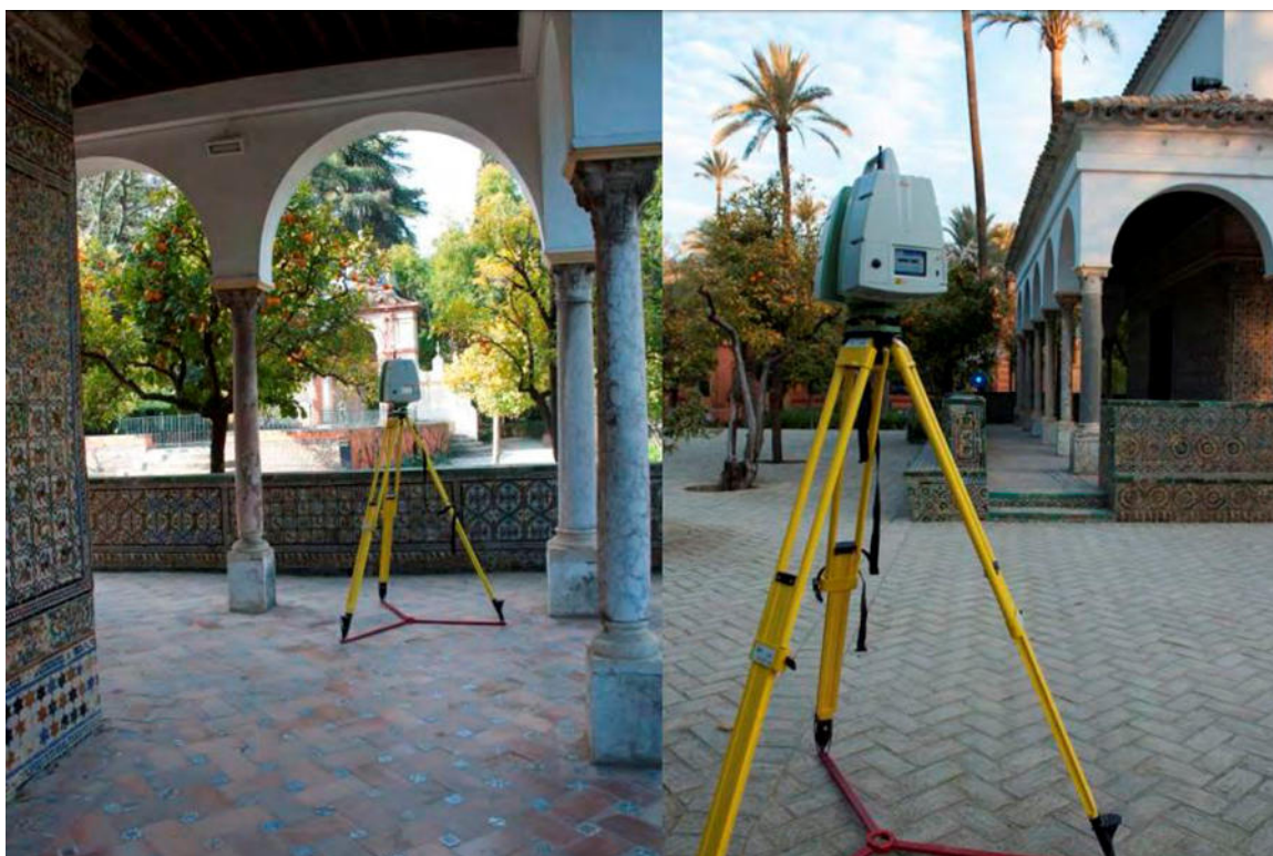
FIGURA 1.26: Emplazamiento de equipos de para escaneo laser.
