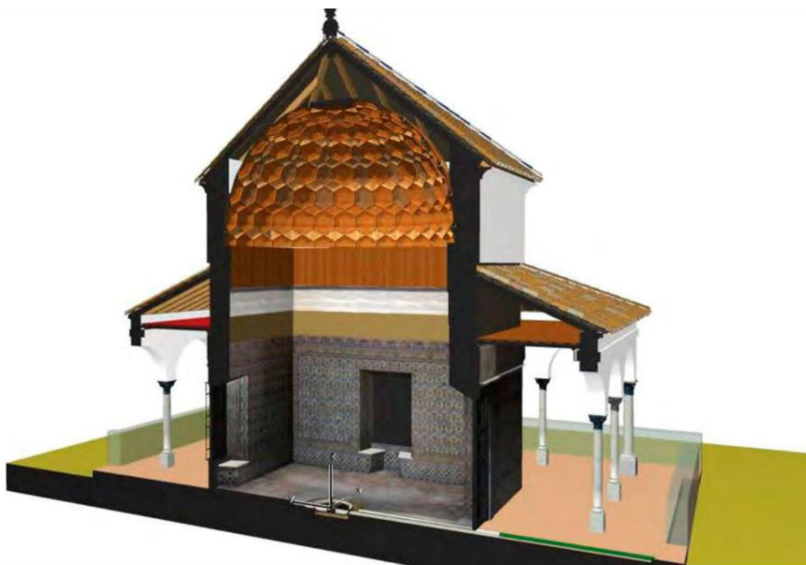
FIGURA 1.27: Sección 3D del Cenador de Carlos V. modelado con ArchiCAD.
