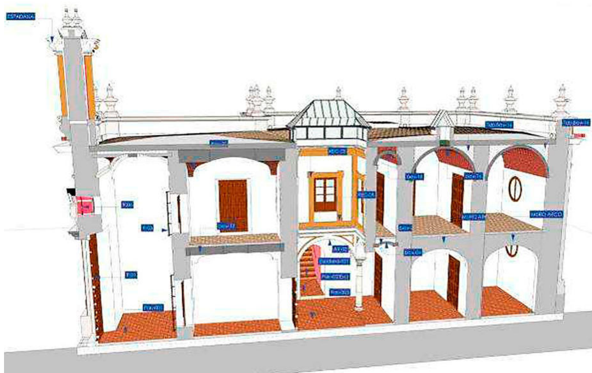
FIGURA 1.30: Sección del modelo de información con ID Identificativos.
