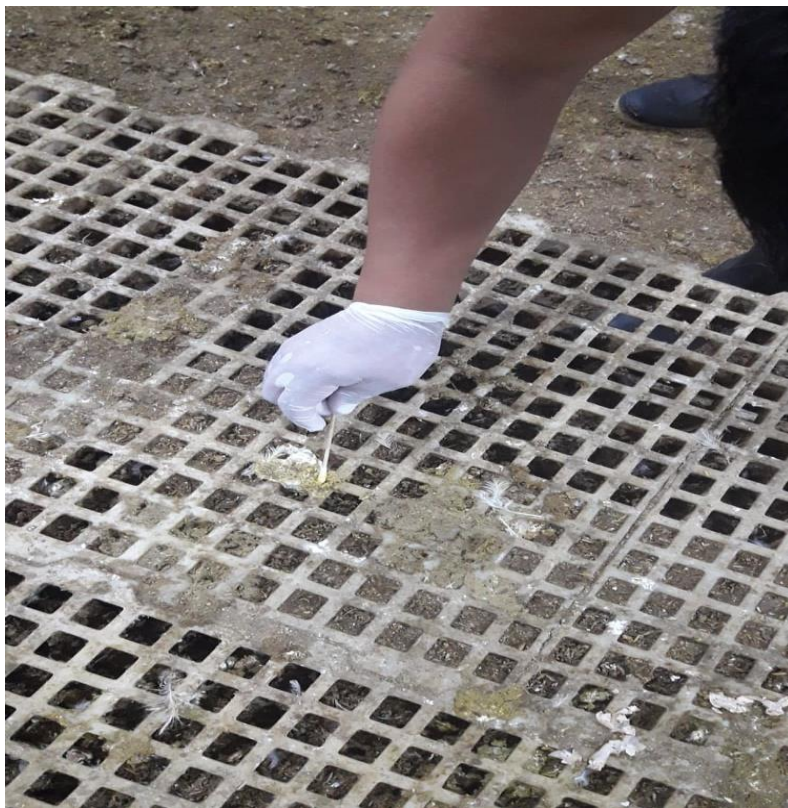
Imagen 4. Toma de muestra de la superficie del suelo
