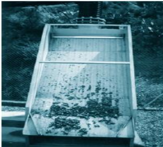
Esquema 7: Tamiz estático auto limpiante
