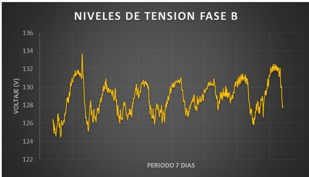
Figura 19: Curva de niveles de tensión Fase B
