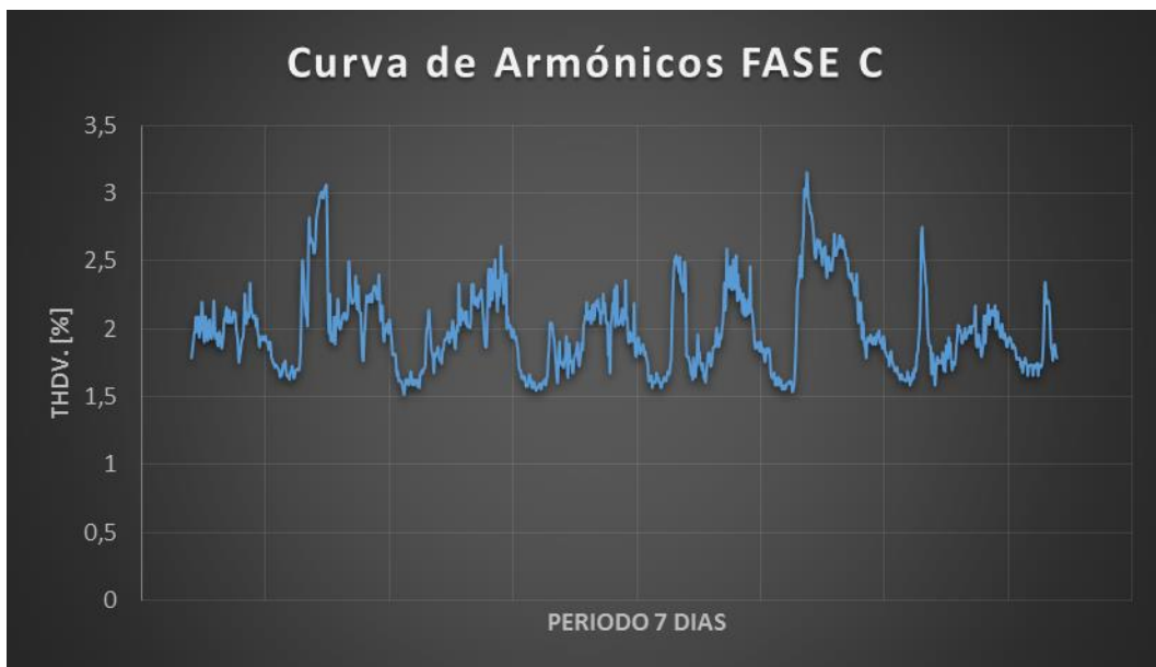
Figura 26: Curva de Armónicos FASE C
