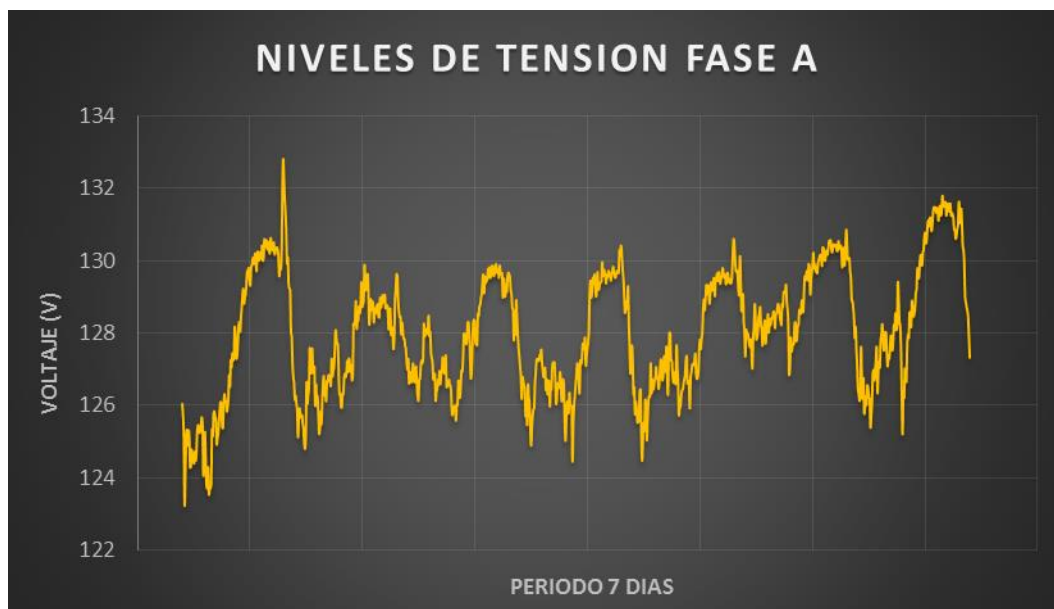
Figura 18: Curva de niveles de tensión Fase A
