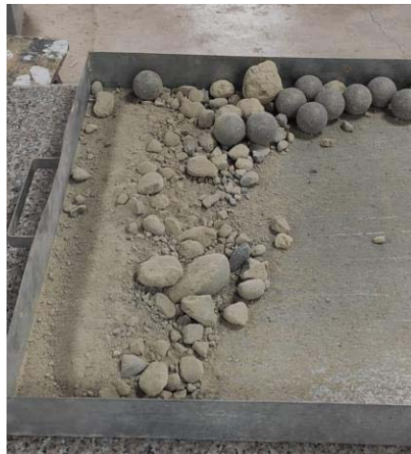
Ilustración 21. Se indica las bolas de acero que trituran las muestras de hormigón.
