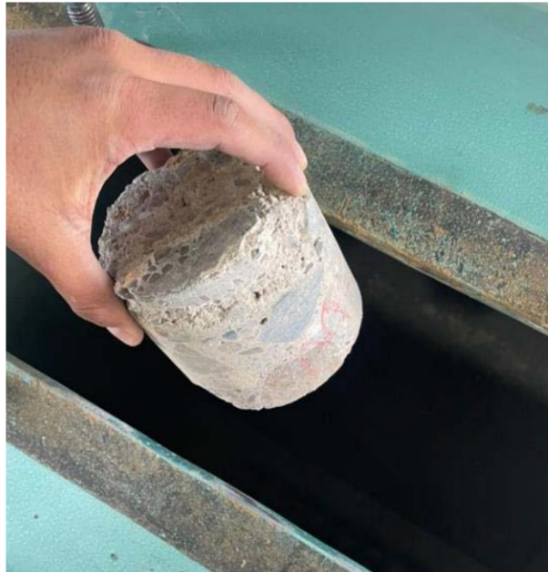
Muestra ingresando a trituradora
