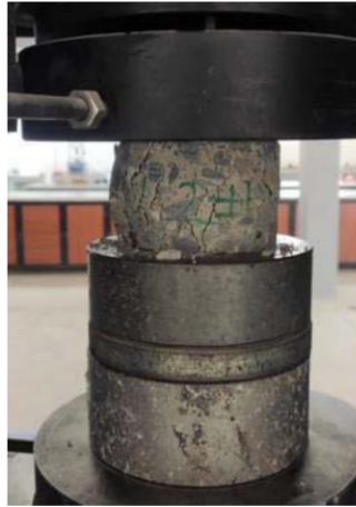
Ilustración 18. Ruptura de cilindro pequeño
