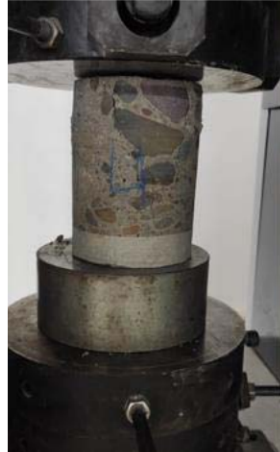
Ilustración 14. Ruptura de cilindro grande
