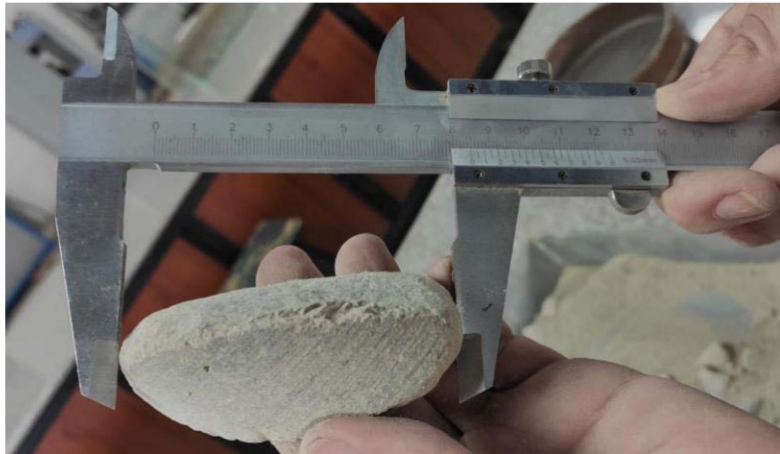
Ilustración 17. Agregados con tamaños muy grandes.
