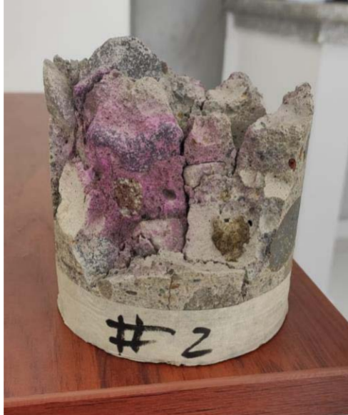
Ilustración 56. Presencia de Carbonatación muestra #2
