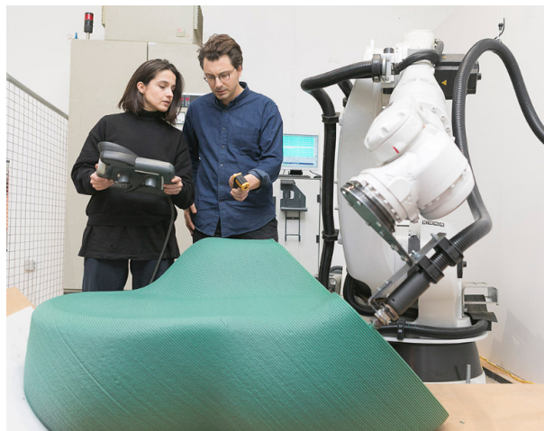
FIGURA 1.24: Imagen de la impresión de mobiliario con residuos plásticos. Fuente: Valencia (2019)
