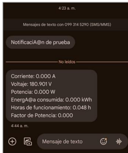
Figura 44. Notificación de prueba de envió de variables mediante modulo GSM
