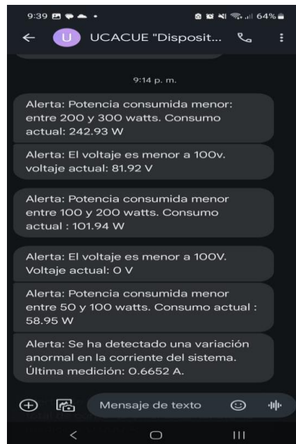
Figura 67. Notificación de alerta de variaciones de corriente, voltaje y potencia consumida.
