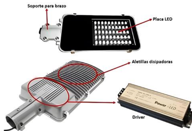
Figura 4. Elementos de una luminaria led.
