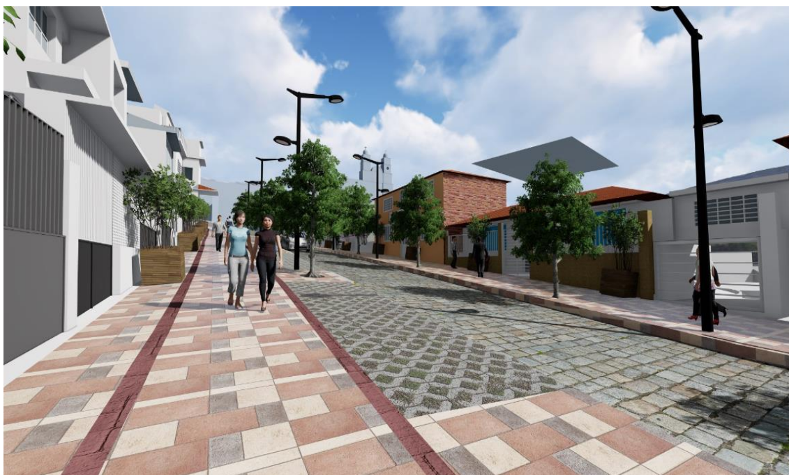
Gráfico 12. Ensanchado de veredas y eliminación de barreras arquitectónicas.
